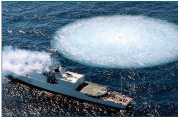
FIG. 1.1: Essai de choc sur navire (source : www.martec.com ).
