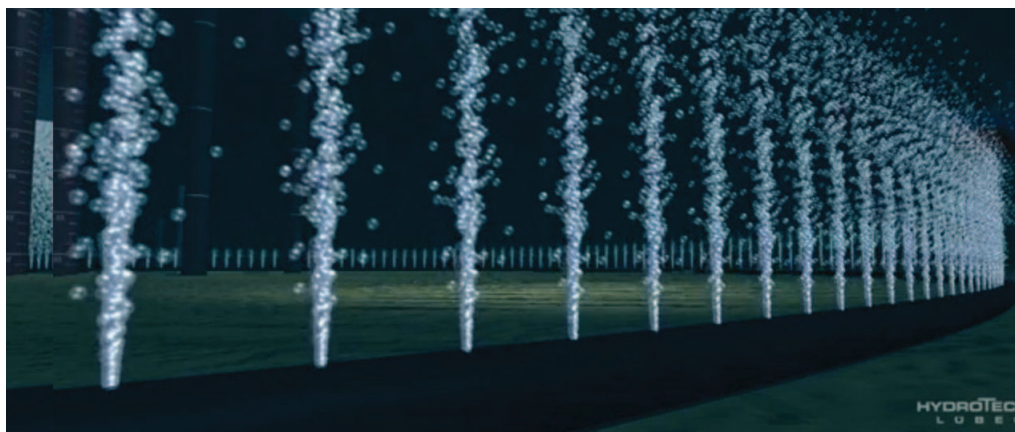
FIG. 1.5: Dispositif de rideau de bulles (source : Hydrotechnik Lübeck).
