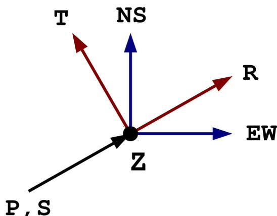
**Figure 2.4** – Schéma de la rotation pour passer du repère (Z–NS–EW) de la station sismologique (bleu) au repère (Z–R–T) du front de l’onde sismique (rouge). La représentation simule une *vue aérienne* de la station sismologique (cercle noir).
