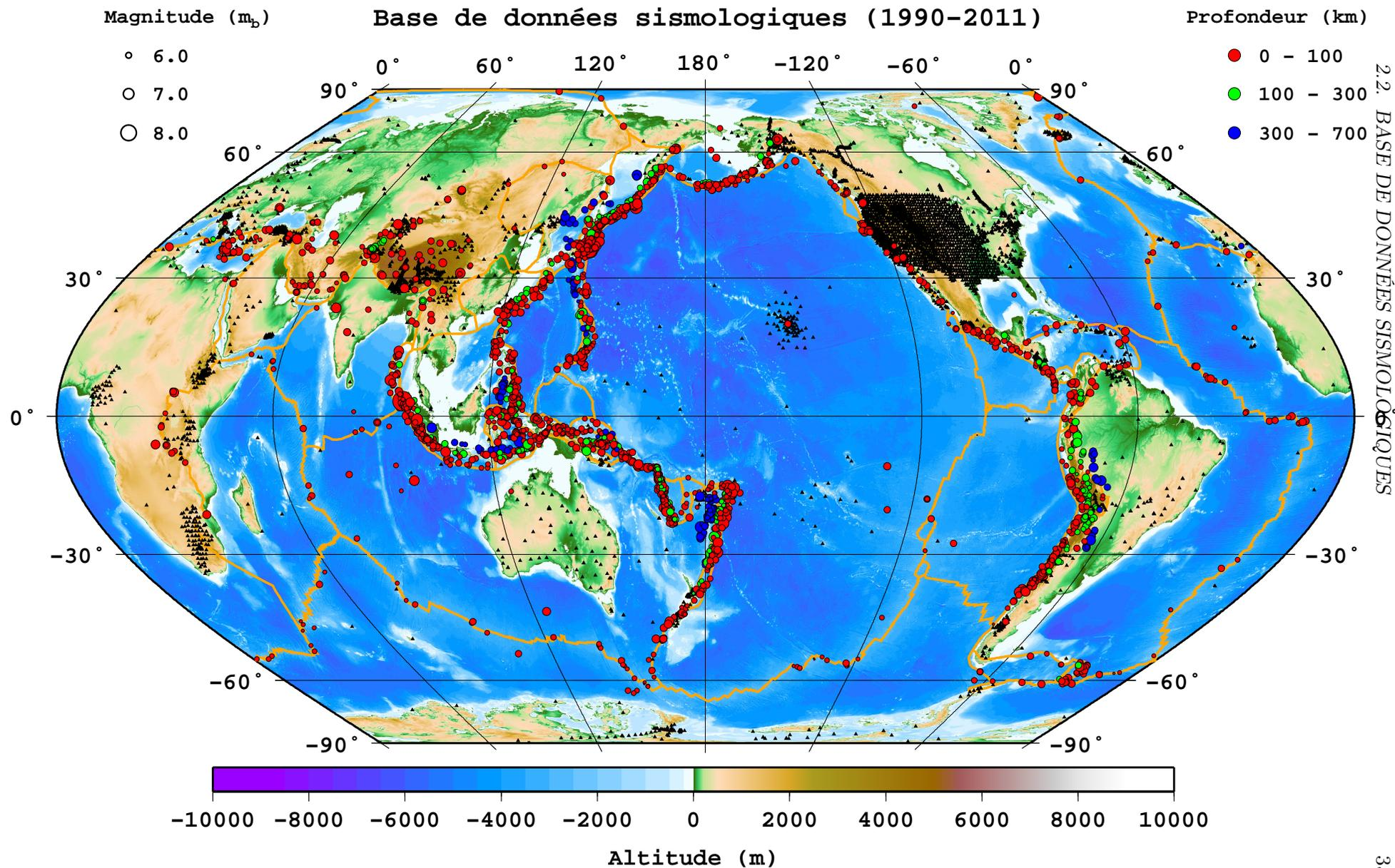
**Figure 2.7** – Position des séismes (cercles de couleur) et stations sismologiques (triangles noirs) composant la base de données actuelle. Les échelles de magnitude et de profondeur sont données au-dessus de la figure. Les limites de plaque tectonique (orange) sont également représentées (d'après Bird, 2003).
