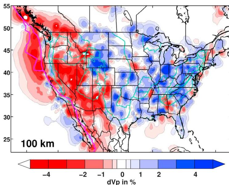
**Figure 3.28** – Anomalies de vitesse des ondes  $P$  sous l'Amérique du Nord, à 100 km de profondeur. Le modèle de Terre de référence utilisé ici est IASP91 [Kennett & Engdahl, 1991]. [extrait de Sigloch, 2011]
