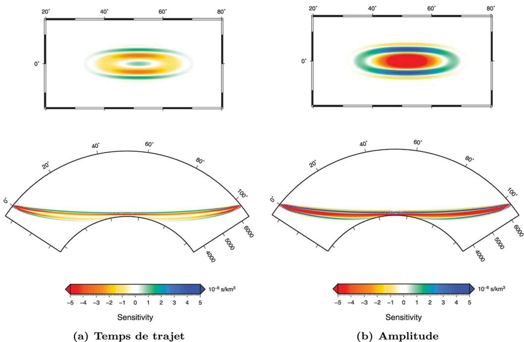
**FIGURE 5.18** – Vues en carte (haut) et sections verticales (bas) de noyaux de sensibilité (a) du temps de trajet et (b) de l'amplitude des ondes  $P$ , pour une phase  $P_{diff}$ , calculés à 1 Hz. [extrait de Fuji *et al.*, 2012]
