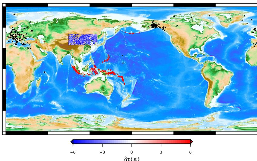
**Figure 3.29** – Configuration des données utilisées dans cette étude. Les résidus de temps de trajet (points bleus) sont représentés au point milieu des trajectoires suivies par les phases  $P_{\text{diff}}$ . Les événements sismiques (étoiles rouges), et les stations d'enregistrement (triangles noirs) correspondants sont également représentés.
