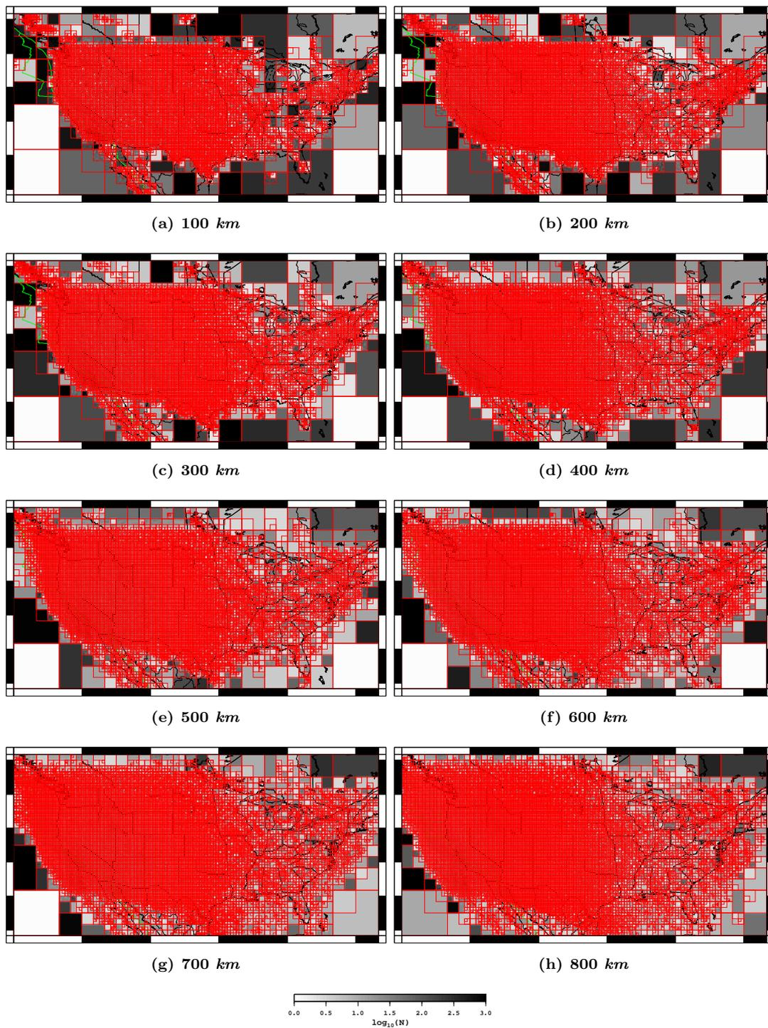
**FIGURE 5.5** – Logarithme de la densité de rais sismiques (nuances de gris) projeté sur la grille régionale sous les États-Unis (cases rouges), à (a) 100, (b) 200, (c) 300, (d) 400, (e) 500, (f) 600, (g) 700 et (h) 800 km de profondeur. La taille des cases indique la taille de la cellule correspondante dans la grille d'inversion.
