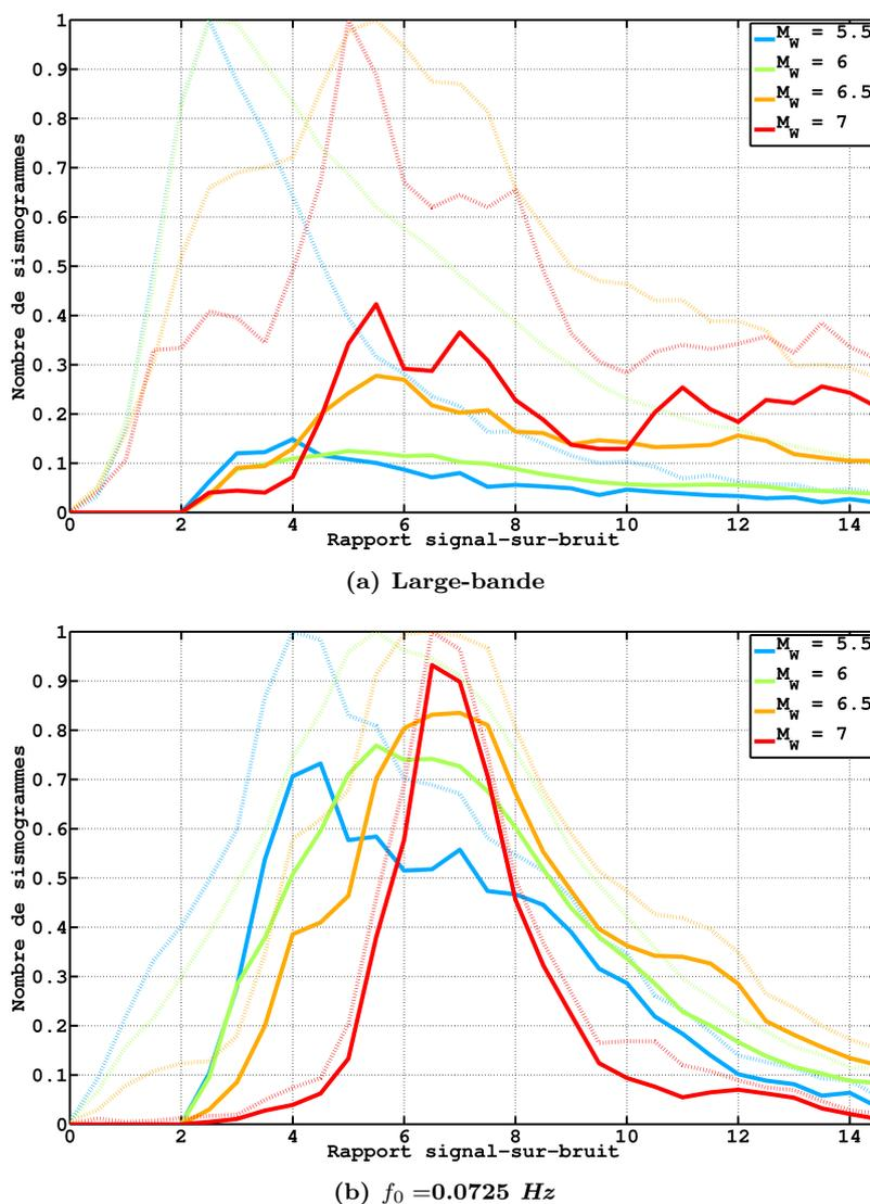
**Figure 3.8** – Comparaison des distributions de sismogrammes avant (pointillés) et après sélection (trait plein), en fonction du rapport signal-sur-bruit *classique*, dans différentes gammes de magnitude (voir légende), et pour des mesures (a) large-bande et (a) à 0.0725 Hz de résidus de phases *P*. Pour faciliter la lecture, les distributions avant et après sélection ont été normalisées de façon identique dans chaque gamme de magnitude.
