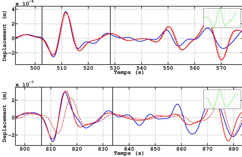
**Figure 2.2** – Mesure de temps de trajet par corrélation croisée entre sismogrammes observé (bleu) et synthétique (pointillés rouges) de phases  $P$  (haut) et  $P_{\text{diff}}$  (bas). Les synthétiques corrigés en temps et en amplitude (rouge) sont également représentés. Les fonctions de corrélation correspondantes sont représentées dans le coin supérieur droit.
