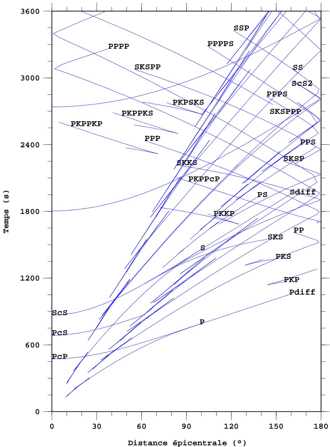
**Figure 2.1** – Courbes de temps de trajet en fonction de la distance épicentrale de la plupart des phases sismiques prédites par le modèle ak135 [Kennett *et al.*, 1995], pour un séisme ayant eu lieu à 300 km de profondeur. Ces courbes ont été réalisées grâce à l'algorithme TauP [Buland & Chapman, 1983].
