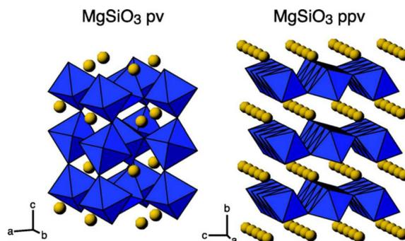
**Figure 1.9** – Structure cristalline de la pérovskite (**gauche**) et de la post-pérovskite (**droite**). Les ions Mg sont représentés par des sphères jaunes, et SiO<sub>3</sub> par des octaèdres bleus. [extrait de Nowacki *et al.*, 2011]
