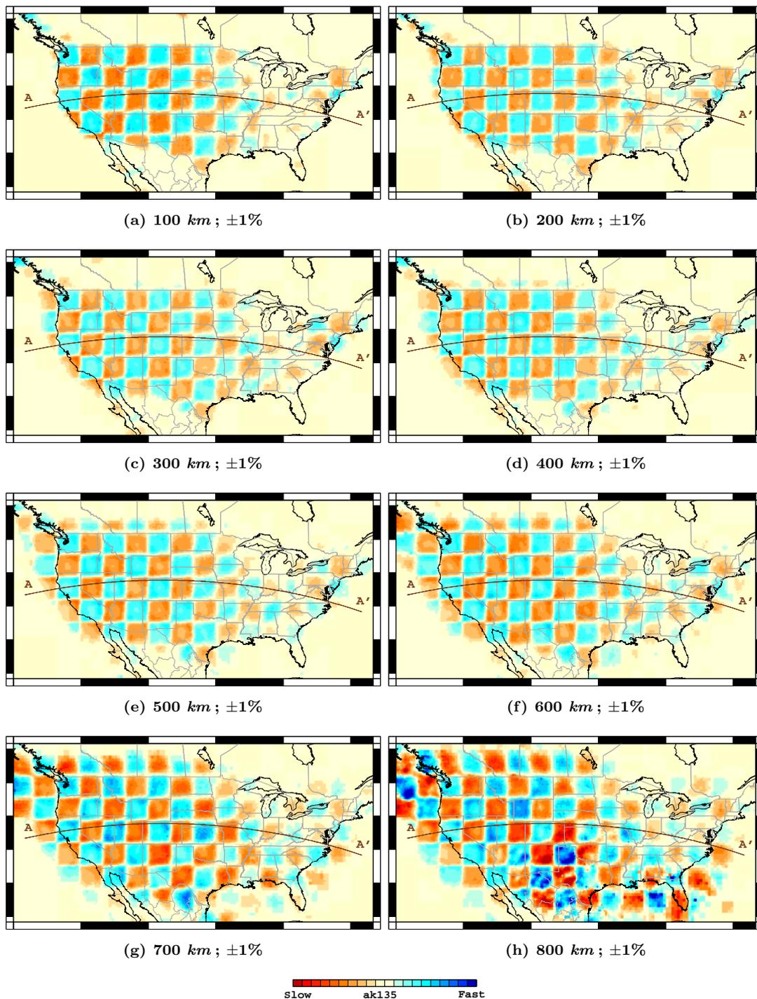
**FIGURE 5.2** – Tests de résolution pour des anomalies de  $4^\circ \times 4^\circ$  de la grille régionale sous les États-Unis à (a) 100, (b) 200, (c) 300, (d) 400, (e) 500, (f) 600, (g) 700 et (h) 800 km de profondeur. L'échelle de couleur donne l'amplitude des anomalies détectées par rapport au modèle de Terre de référence ak135, les valeurs minimales/maximales étant indiquées sous chaque figure.
