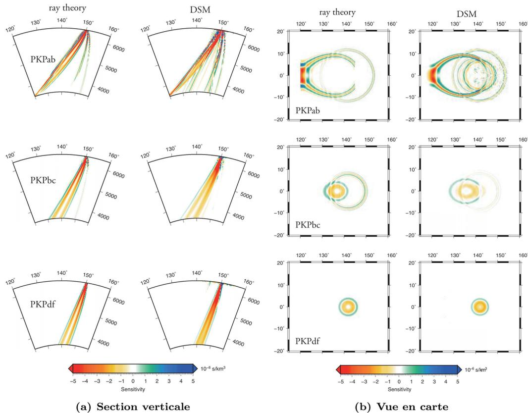
**FIGURE 5.17** – Comparaisons de (a) sections verticales et (b) de vues en carte de noyaux de sensibilité du temps de trajet des ondes  $P$ , calculés avec la théorie des rais (gauche) et avec DSM à 1.25 Hz [Geller & Ohminato, 1994] (droite), pour des phases  $PKP_{ab}$  (haut),  $PKP_{bc}$  (milieu), et  $PKP_{df}$  (ou  $PKIKP$ ) (bas), pour une distance épacentrale de  $150^\circ$ , et une source explosive à 20 km de profondeur. [extrait de Fuji *et al.*, 2012]
