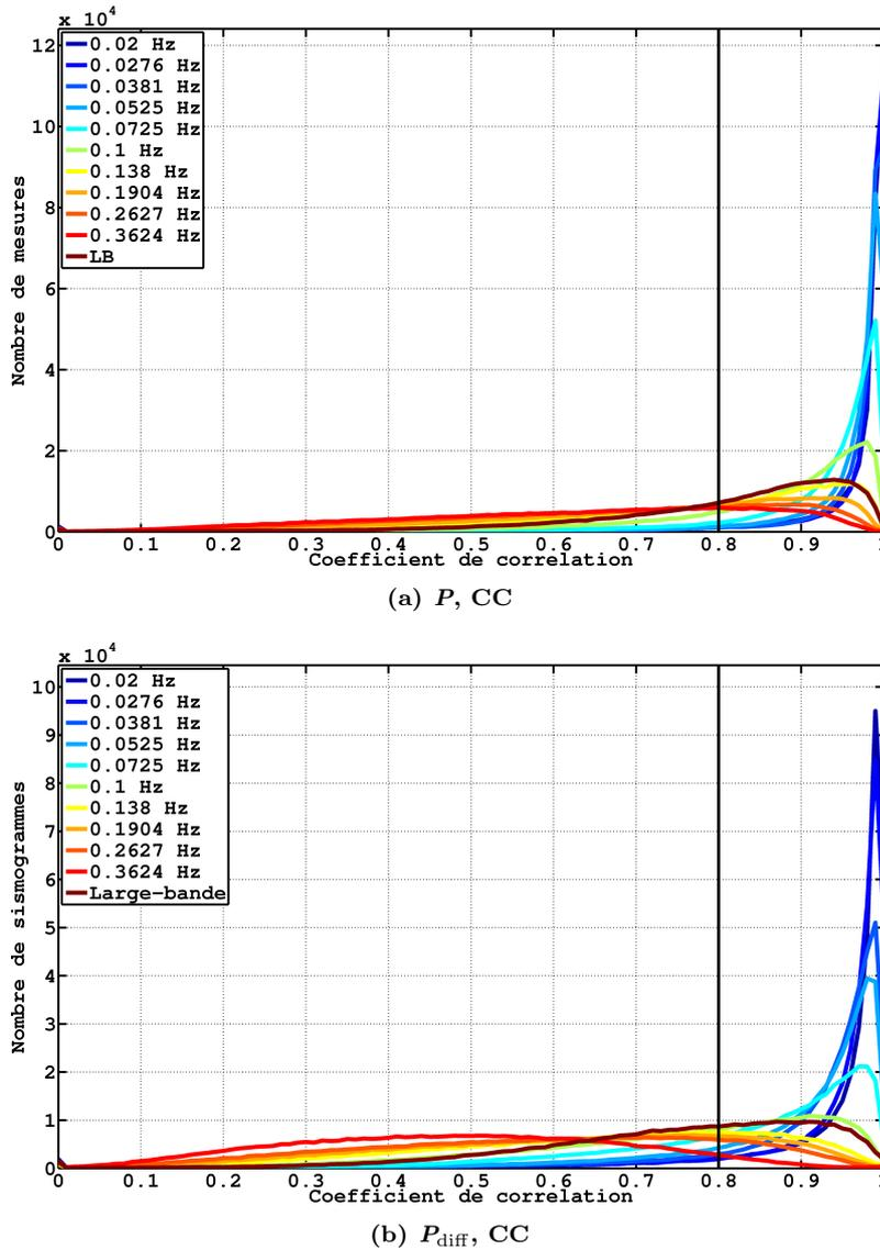
**Figure 3.6** – Distributions des mesures de l'ensemble de la base de données selon le coefficient de corrélation, pour les phases (a)  $P$  et (b)  $P_{\text{diff}}$ . L'échelle de couleur donne la fréquence centrale du filtre appliqué et la ligne verticale noire le seuil de pré-sélection appliqué dans la section suivante ( $CC_0 = 0.8$ ).
