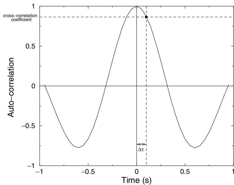
**Figure 2.26** – Illustration de l'estimation de l'erreur sur la mesure du résidu de temps de trajet. La ligne pleine montre la fonction d'auto-corrélation du sismogramme synthétique. Celle-ci est égale au coefficient de corrélation entre le sismogramme observé et le sismogramme synthétique au point marqué d'un cercle noir. L'instant auquel la fonction d'auto-corrélation passe par ce point détermine l'erreur sur le résidu de temps, noté ici  $\Delta\tau$ . [extrait de Chevrot, 2002]
