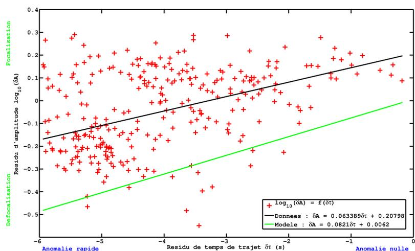
**Figure 3.31** – Résidu d’amplitude en fonction du résidu de temps de trajet correspondant. Les tendances générales des données observées (ligne noire), et modélisées (ligne bleue) sont également représentées (équations en légende). Les données modélisées correspondent à la variante  $v_P + 3\%$  du modèle ak135 [Fig. 3.32(a)].
