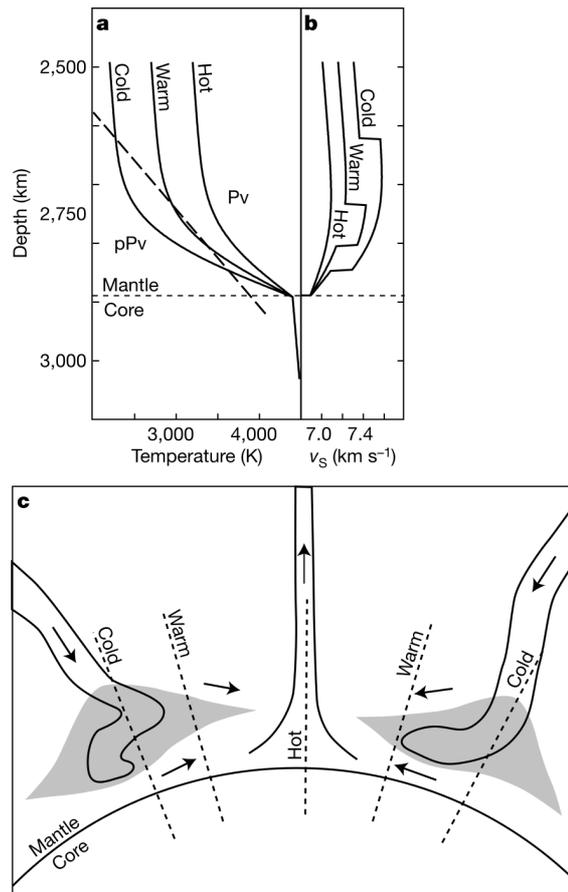
**Figure 1.10** – (a) Relation entre trois géothermes et transition de phase pPv. (b) Profil de vitesse correspondant. (c) Schéma de possibles structures du manteau inférieur. La couche de pPv est indiquée en gris, la direction des flux est donnée par les flèches, et les géothermes sont donnés en pointillés. [extrait de Hernlund *et al.*, 2005]
