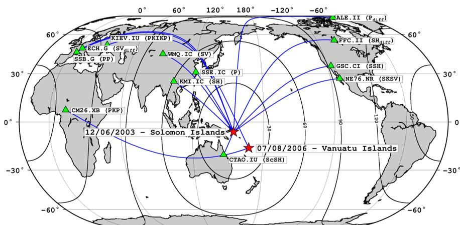
**Figure 2.12** – Carte situant le séisme du 12/06/2003 (étoile rouge) et les stations (triangles verts) ayant enregistré les sismogrammes présentés dans les exemples des Fig. 2.13 – 2.24. Les lignes bleues donnent les trajectoires des différentes phases sismiques, et les lignes noires sont des isocontours en termes de distance épicentrale par rapport à l'épicentre du séisme.
