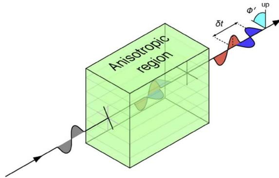
**Figure 1.13** – Déphasage des ondes de cisaillement dans un matériau anisotrope. Le retard entre les deux ondes est  $\delta t$ , et l'axe rapide du matériau, dans le repère du front d'onde, est  $\phi'$ . [extrait de Nowacki *et al.*, 2011]
