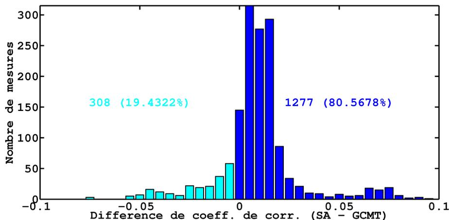
**Figure 3.3** – Histogramme des différences de coefficient de corrélation entre ondes  $P$  observées et synthétiques en utilisant les STF obtenues par SAWIB (SA) et celles du projet *Global Centroid Moment Tensor* (GCMT). Les nombres et pourcentages indiquent les quantités de données pour lesquelles la différence de coefficient de corrélation est négative (cyan), ou positive (bleu). [d’après Garcia *et al.*, 2012]
