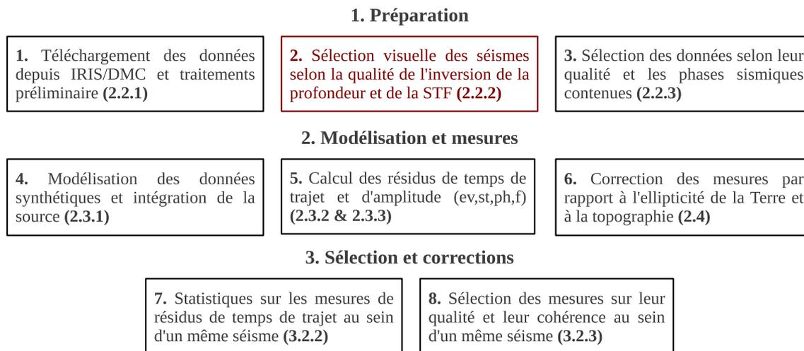
**Figure 2.3** – Schéma résumant les différentes étapes de la méthode automatique de mesure de résidus de temps de trajet. La case représentée en rouge indique la seule étape nécessitant une intervention manuelle de sélection visuelle sur la qualité de l'inversion de la profondeur et de la fonction source des séismes. Les références entre parenthèses indiquent les sections correspondantes dans la suite du mémoire [Chap. 2 & 3].
