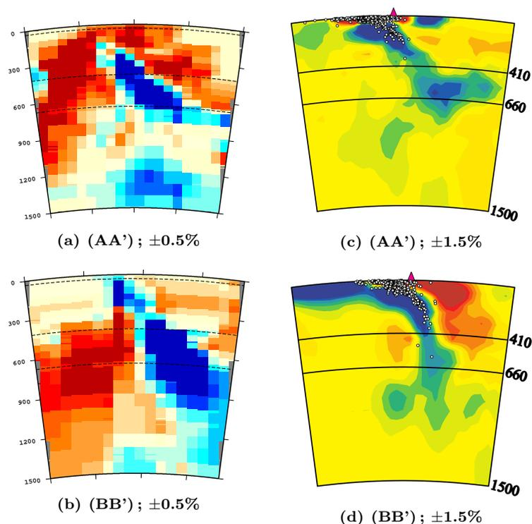
**FIGURE 5.16** – Comparaison de coupes verticales entre notre modèle et un modèle régional de la zone de subduction Andaman-Sumatra [Pesicek *et al.*, 2008], selon les deux sections représentées sur la Fig. 5.15. L'échelle de couleur donne l'amplitude des anomalies par rapport au modèle de Terre de référence ak135, les valeurs minimales/maximales étant indiquées sous chaque figure. [d'après Pesicek *et al.*, 2008]
