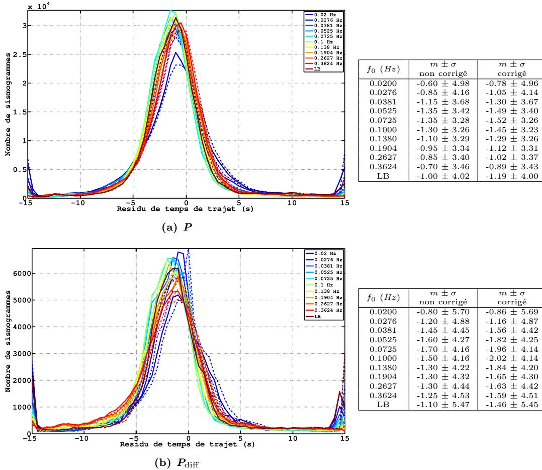
**Figure 2.25** – Distribution des résidus de temps de trajet avant (trait plein) et après (tiret pointillés) correction des effets de l'ellipticité et de la topographie à la station, pour des résidus mesurés sur des phases (a)  $P$  et (b)  $P_{diff}$ . La légende donne les gammes de fréquence correspondant à chaque couleur. Les valeurs des médianes et écarts-types correspondants sont données dans les tableaux adjacents.
