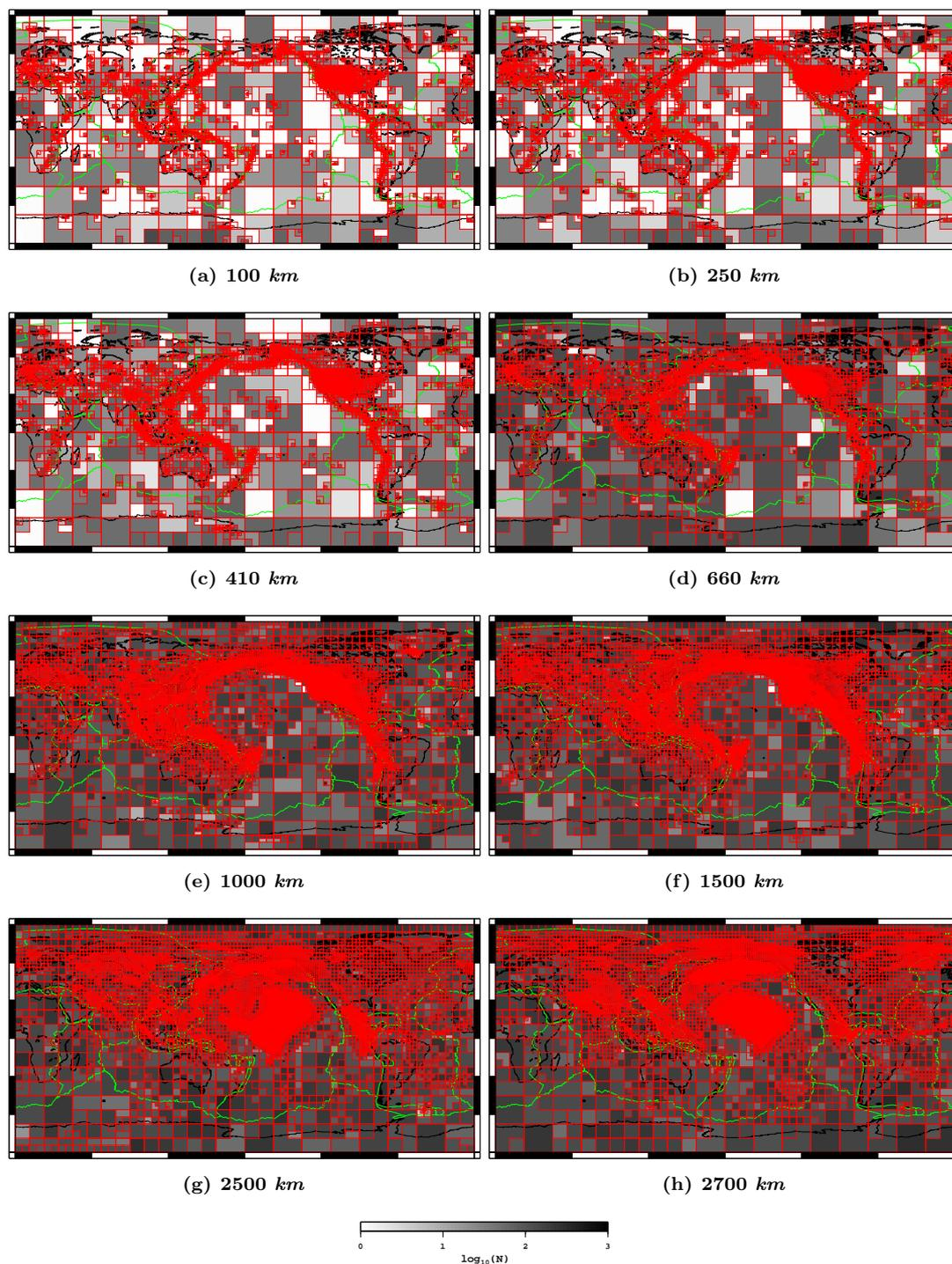
**FIGURE 5.11** – Logarithme de la densité de rais sismiques d’ondes  $P$  projetée sur la grille d’inversion globale, à (a) 100, (b) 250, (c) 410, (d) 660, (e) 1000, (f) 1500, (g) 2500 et (h) 2700 km de profondeur. La taille des cases indique la taille de la cellule correspondante dans la grille d’inversion.
