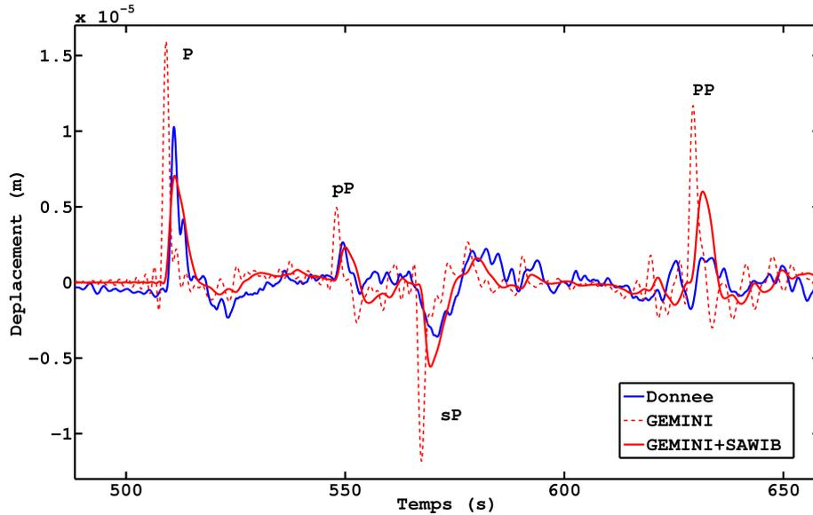
**Figure 2.9** – Comparaison d’un sismogramme observé (bleu) avec un sismogramme synthétique directement issu de GEMINI (pointillés rouges) ou convolué par la STF correspondante (rouge). Les principales phases sismiques présentes sur cette portion du sismogramme sont indiquées.
