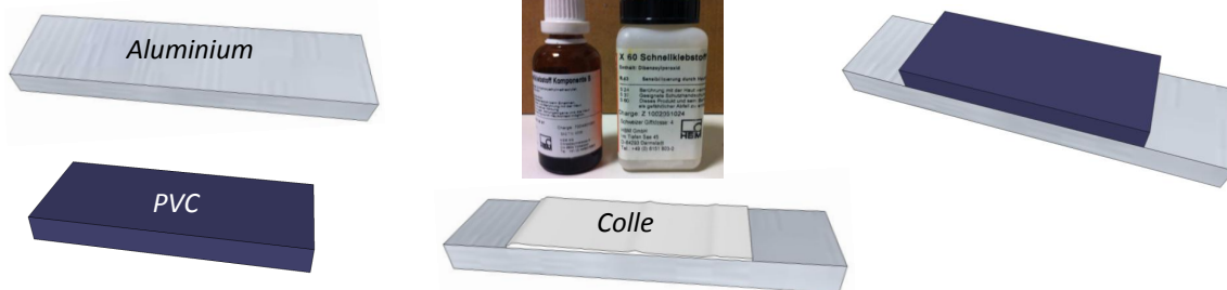
FIGURE B.11 – Étapes de réalisation de l'éprouvette Alu/PVC
