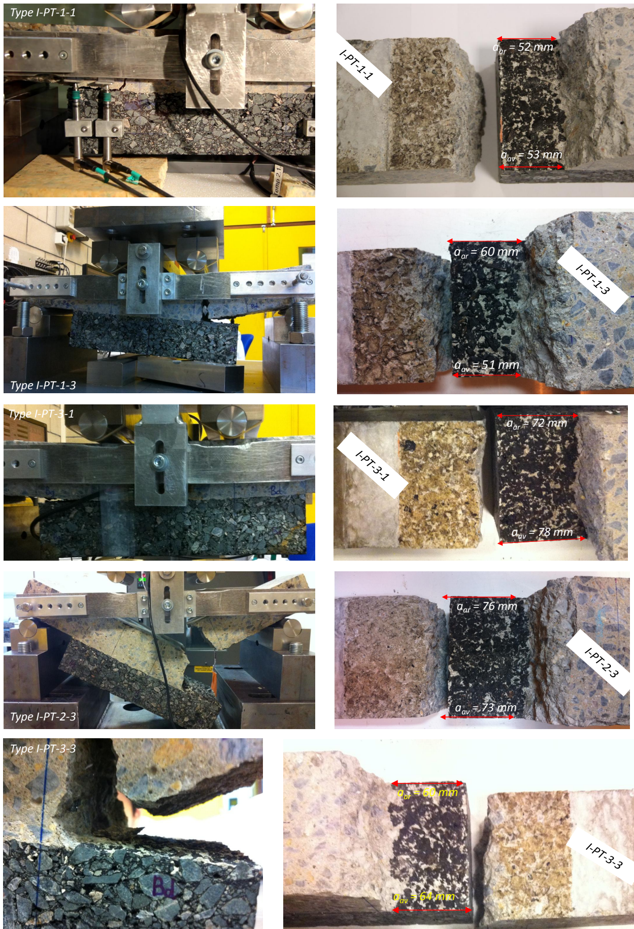
FIGURE 5.2 – Aspect visuel des ruptures d'interface des éprouvettes de type I
