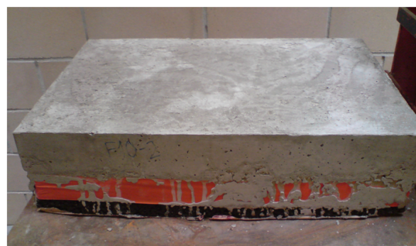
FIGURE B.7 – Plaque bicouche après décoffrage
