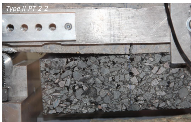
FIGURE 5.3 – Aspect visuel des ruptures d'interface des éprouvettes de type II
