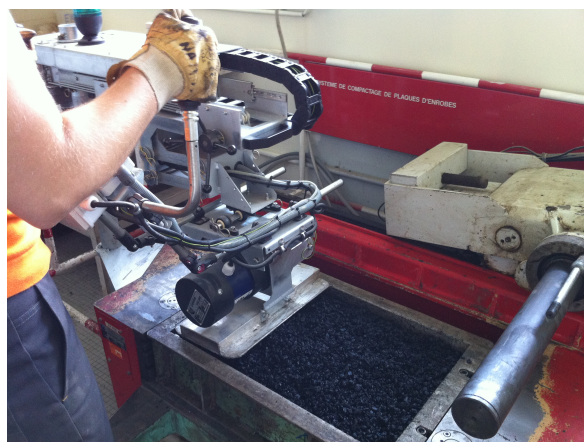
FIGURE B.2 – Banc de compactage MLPC au LRPC Angers
