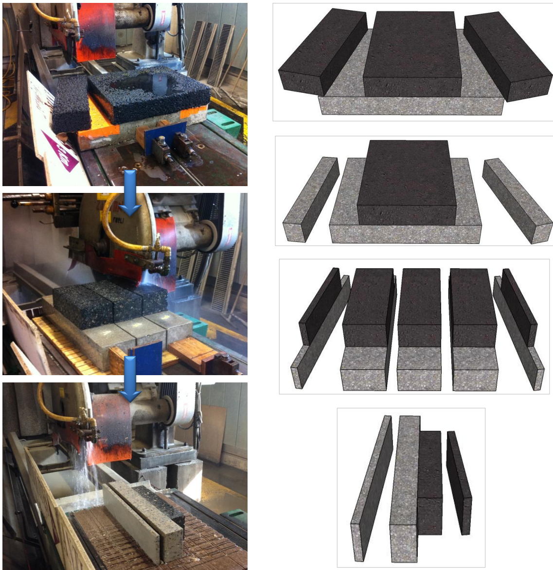
FIGURE B.10 – Étapes de sciage de la plaque pour obtenir la géométrie de l'éprouvette
