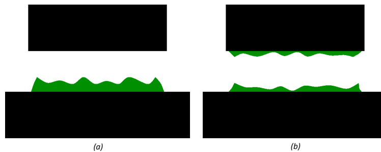
FIGURE 1.13 – Schéma d'une rupture (a) adhésive ; (b) cohésive
