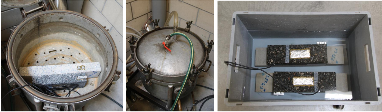
FIGURE 6.2 – Protocole de saturation des éprouvettes dans une cloche à vide
