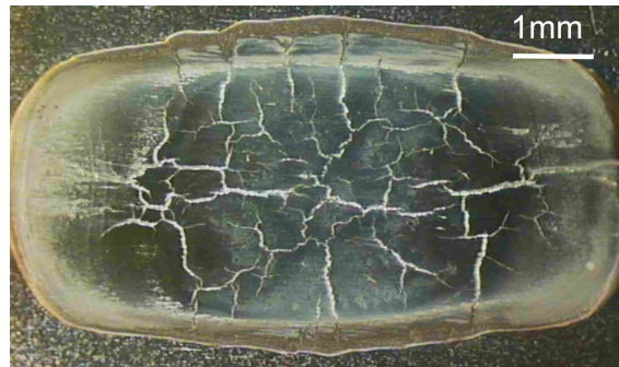
Figure 2 : Exemple d’observation de réseaux en fatigue thermique issu des travaux de Maillot [2003], cas d’un acier 304L avec \delta T = 150^{\circ}\text{C} et un T_{max} = 320^{\circ}\text{C} - Image prise après 300 000 cycles.
