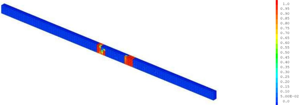
Figure 2-45 : Initiation de l'endommagement (scalaire D) perpendiculairement au renfort d'acier dans la partie centrale du tirant (coupe dans le plan du renfort d'acier)
