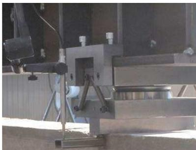
Figure 4-11 : Mesure du déplacement d'un appui
