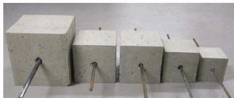
**Figure 3-23 : Les différentes éprouvettes testées (de de gauche à droite : HA16, HA12, L12, HA10, HA8)**
