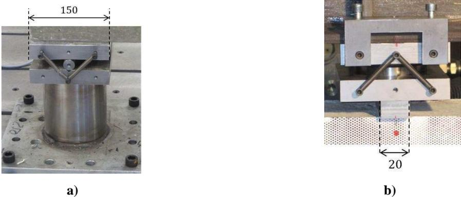
Figure 4-9 : Appuis (dimensions en mm)
