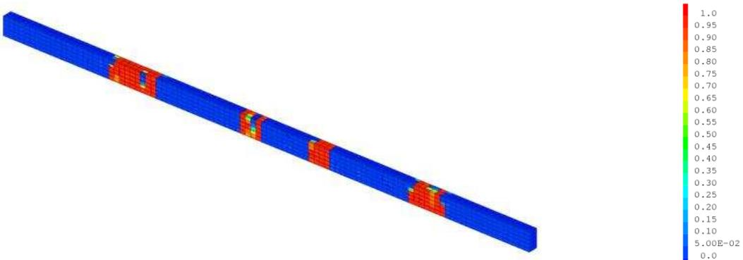
Figure 2-47 : Répartition de l'endommagement (scalaire D) le long du tirant en fin de chargement (coupe dans le plan du renfort d'acier)
