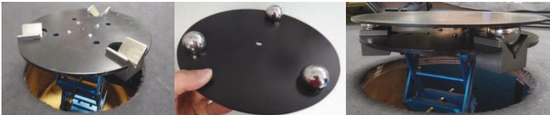
Figure 5.5 – Système de positionnement intégré au SISD
