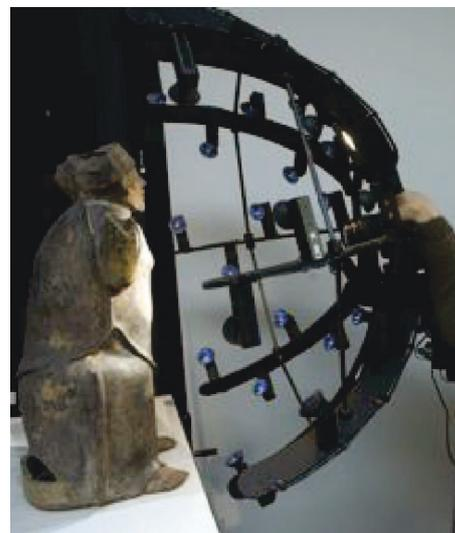
(b) Dispositif d'acquisition des PTMs
