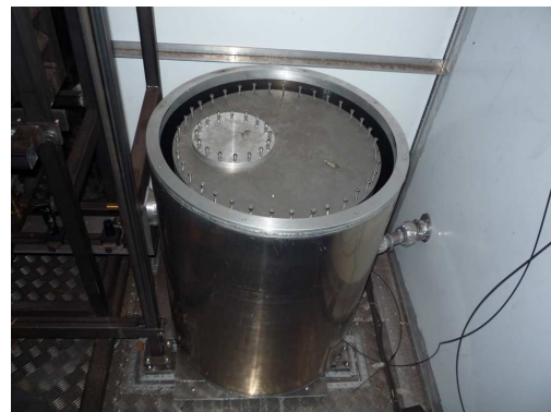
FIGURE 1.23 – Photographie illustrant la double virole "in-situ". Cet ensemble ainsi que le support pour les miroirs est posé sur des bases ancrés dans le sol, indépendamment de la cage de Faraday principale.
