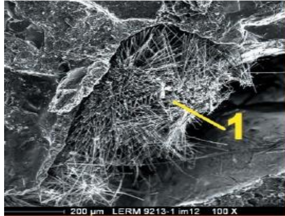
Figure 3 Photo au MEB d'une ettringite qui peut s'étendre dans un pore (SKALNY, MARCHAND et ODLER 2002).
