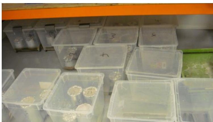
Figure 28 Photos des éprouvettes au contact de différentes solutions dans les bacs de diffusion.
