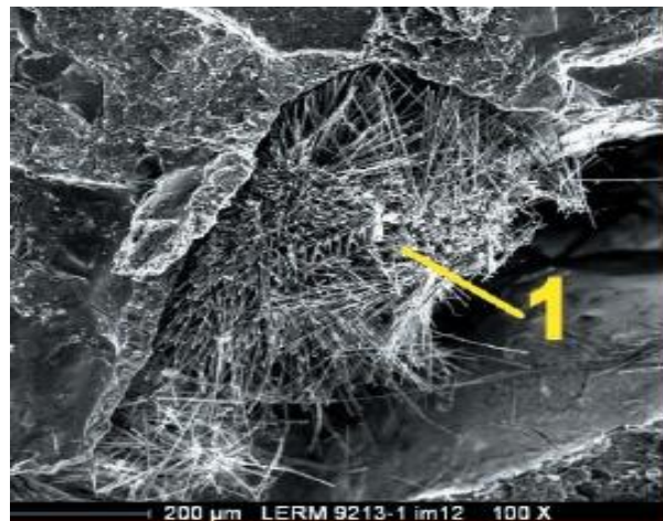
Figure 22 Photo au MEB d'une ettringite secondaire ayant de la place pour se développer dans un pore (NEVILLE 2004).
