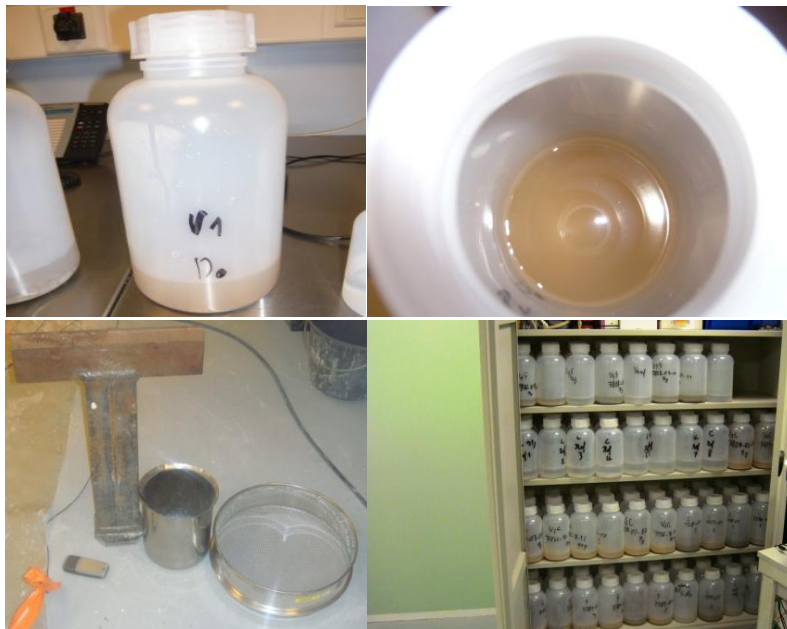
Figure 32 Photos des bidons de 2 L servant aux expériences d'interactions (en haut), du matériel de broyage et tamisage manuel (bas gauche) et de l'armoire hermétique où ils sont stockés (bas droite).
