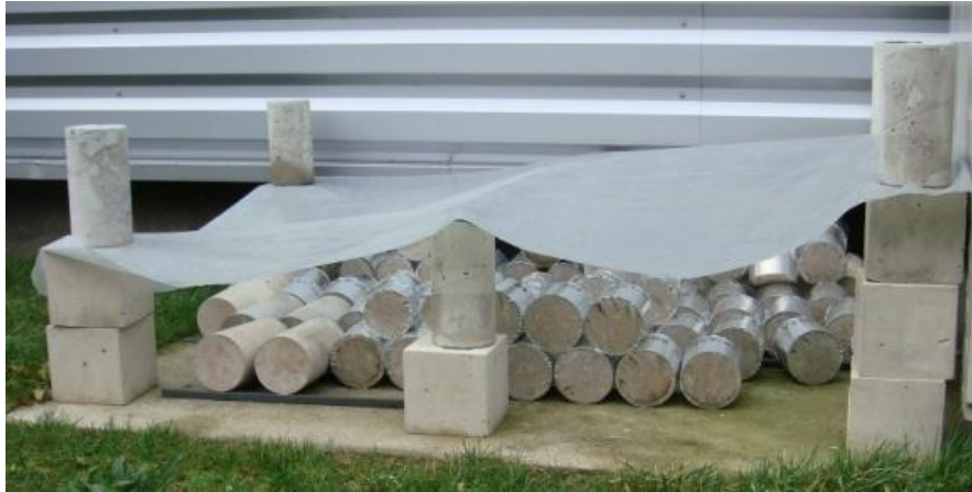
Figure 25 Photos des éprouvettes laissées en extérieur et protégées de la pluie.
