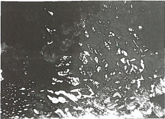
Fig. 10. Perthites en "gouttelettes" (au centre) et en "plumes" (coin inférieur droit) dans une leptite. (L. P. x 100)
