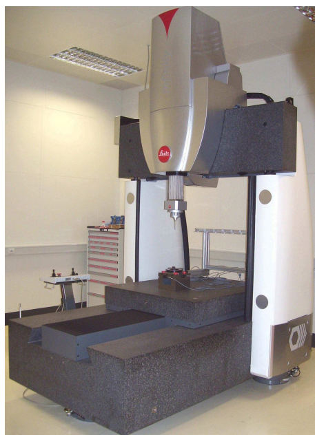
FIG. 3.17 – La CMM Leitz, opérationnelle au CERN le 9 novembre 2010
