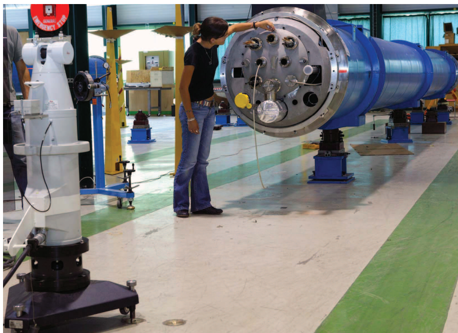
FIG. 2.33 – Fiducialisation d'un cryodipôle du LHC au laser tracker
