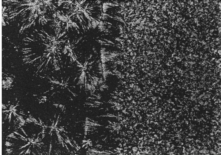
Figure 19 : photographie de microscopie optique en lumière polarisée de sphérolites d'un polypropylène vierge (à gauche) et d'un mélange PP/CaCO<sub>3</sub> (à droite) [Puk94].
