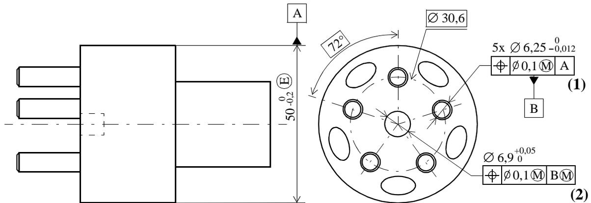
Figure V.1: Dessin (simplifié) du porte-satellites.
