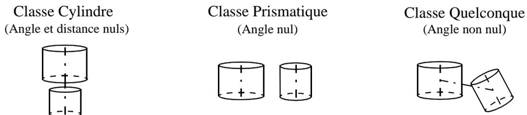
Figure II.3: Reclassement de l'association de deux cylindres.
