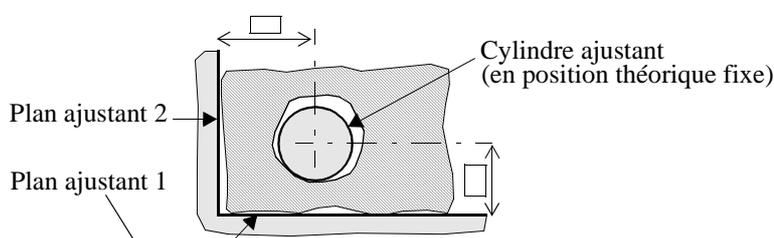
Figure IV.22: Mesure de la dimension fonctionnelle de l'alésage.
