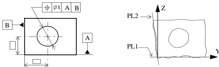
Figure III.2: Construction d'un dièdre de référence par l'approche actuelle.
