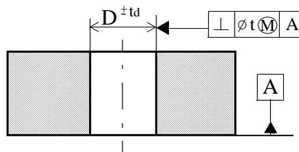
Figure I.27: Cotation suivant l'exigence du maximum de matière.
