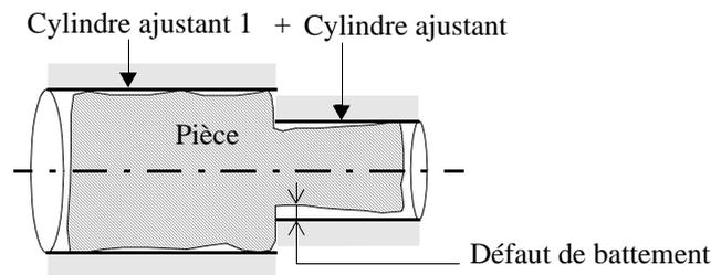
Figure IV.20: Mesure d'un défaut de battement radial.
