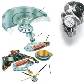
Figure I-10 Micro-dynamo dans une montre bracelet, puissance moyenne 5\mu\text{W} (Seiko Kinetic)
