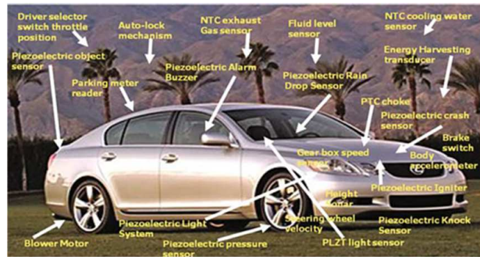
Figure 0-2 Placement des différents capteurs sur une voiture [5]
