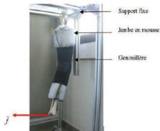
Figure 0-11 Illustration de la récupération de l'énergie d'extension/compression sur le genou [17]
