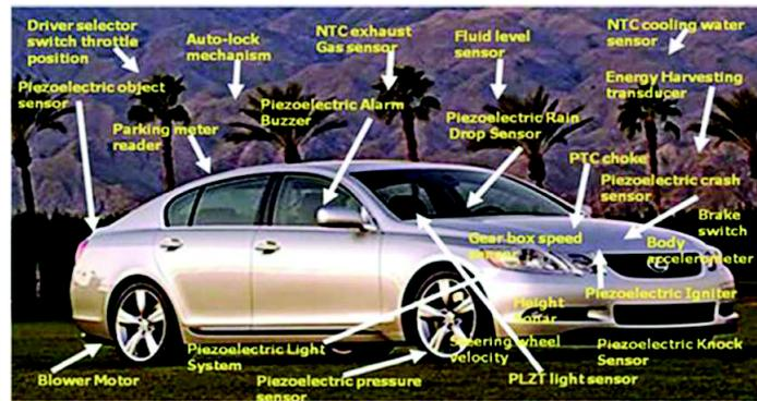
Figure 0-2 Placement des différents capteurs sur une voiture [5]
