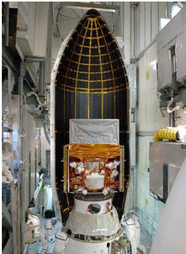
FIG. II.2 – GLAST lors de sa phase de préparation au lancement, dans la coiffe d'une fusée Delta II.
