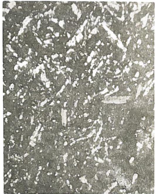
Un fond brouillé, produit de l'altération de minéraux préexistants, montre, entre autres, de la chlorite, de l'antigorite, des mouchetures de minéraux opaques.
