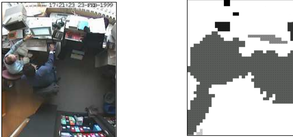
Figure 27 : A gauche une image d'offsat, à droite les zones de mouvement en grisé résultant d'un traitement automatisé des images d'offsat (Lahlou, 2008c)
