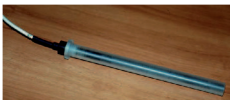
FIGURE 10.5 – Chambre à ionisation de type crayon pour la mesure d'un débit de dose
