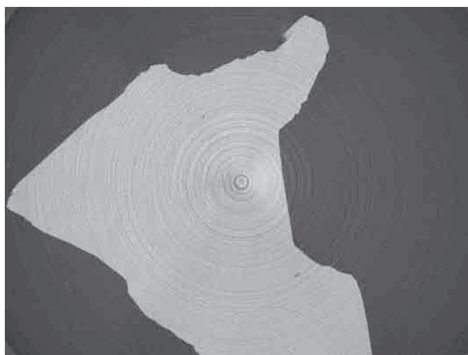
FIGURE 2.30 – Coupe 2D obtenue en micro-tomographie synchrotron présentant des "ring artefacts"
