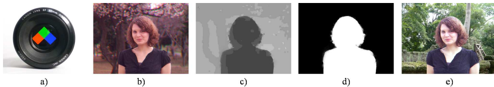
FIGURE 2.14 – Illustration de l'objectif dont la pupille est composée de trois filtres colorés (a). Cet objectif permet d'obtenir une image avec un décalage chromatique en fonction de la distance (b). Ce décalage permet de reconstruire la carte de profondeur de la scène (c), où les zones sombres sont les plus proches. Cette carte permet d'isoler un objet de la scène (d), voire de l'introduire dans une autre scène (e) [53].
