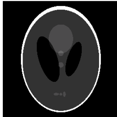
FIGURE 5.15 – Illustration de l'image dite fantôme de Shepp Logan , composée de 10 ellipses de tailles, d'orientations et d'intensités différentes. Cette image constitue une référence pour tester et comparer les algorithmes d'imagerie comprimée [30].
