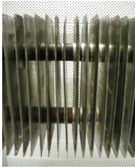
Figure 4.2. Illustration du défaut d'écartement entre les ailettes.
