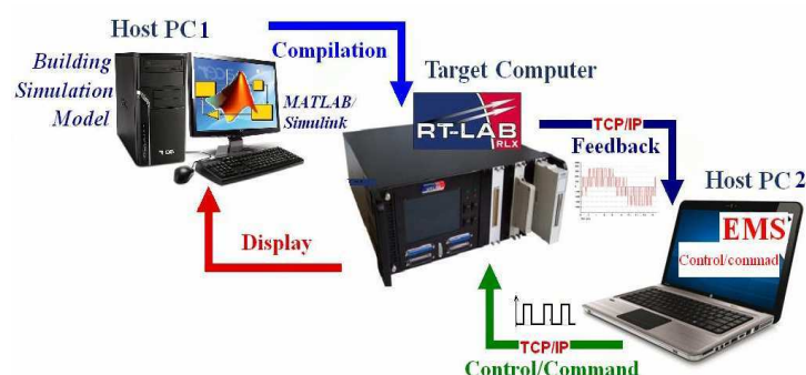
Figure III-17: Schéma conceptuel de la plate-forme HIL
