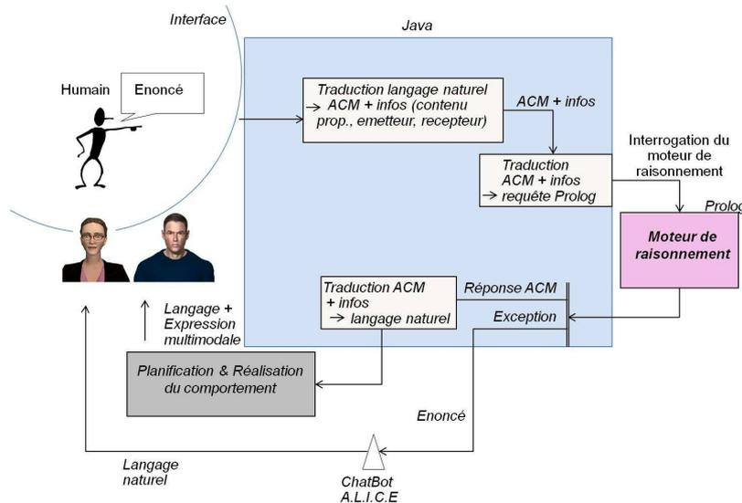
FIG. 13.1 – Architecture logicielle du système
