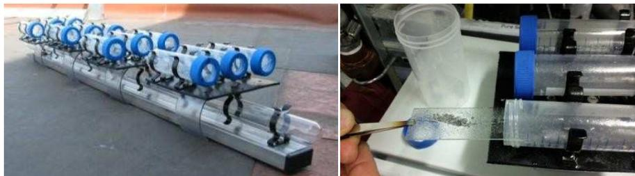
**Figure 54 : Supports des lames de verre placés dans la TAR traitée au ClO<sub>2</sub> et récupération d'une lame de verre pour analyse**
