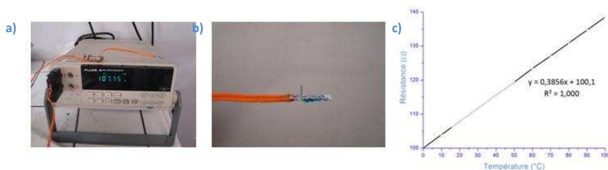
Figure 48 : a) Multimètre de la Pt100 b) Sonde Pt100 c) Droite de conversion de la résistance en température sur l'intervalle d'étude
