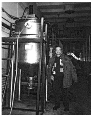
Figure 10 : Extracteur ultrasonore 1000 L, de l'entreprise Plafar, Roumanie
