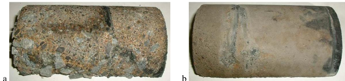
Figure I-23 : Echantillons de béton exposés pendant 17 mois dans le cadre du projet Virginia [41].
