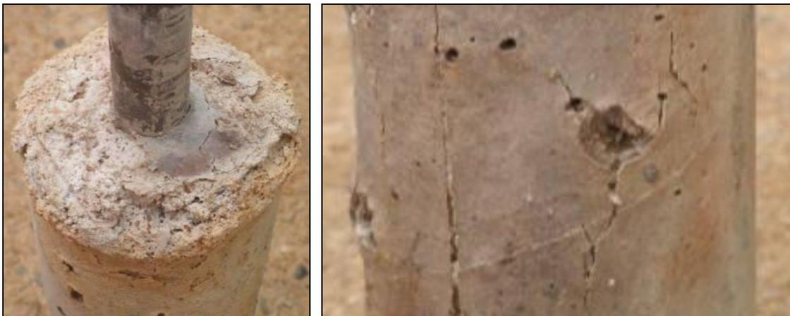
Figure III-14 : Détails des dégradations observées sur des échantillons de mortier CEM III sur le site S2.
