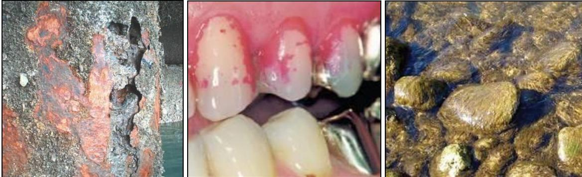
**Figure I-4 : Exemples de biodétérioration de différents matériaux : canalisation métallique, dents, pierres dans une rivière.**
