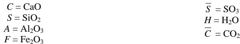
Le ciment courant est constitué principalement de clinker qui est obtenu à partir d'un mélange de calcaire et d'argile, dans des proportions moyennes de 80% et 20% respectivement. Ce mélange est intimement homogénéisé puis cuit à 1450°C et refroidit brusquement. Le clinker ainsi obtenu est broyé finement et additionné de constituants secondaires suivant le type de ciment recherché. Il existe cinq types de ciment courant répondant à des applications particulières :
