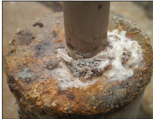
Figure III-11 : Détail de la face supérieure d'un échantillon de mortier CEM I exposé 375 jours sur le site S1.
