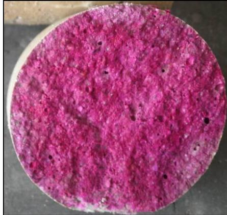
**Figure IV-58 : Test à la phénolphthaléine sur la section de l'échantillon de mortier CAC+S immergé pendant 40 jours dans une solution d'acide sulfurique à pH 4,5.**
