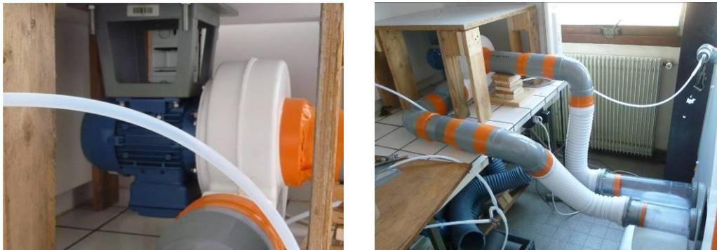
**Figure V-6 : Système de ventilation de l'enceinte de biodétérioration.**
