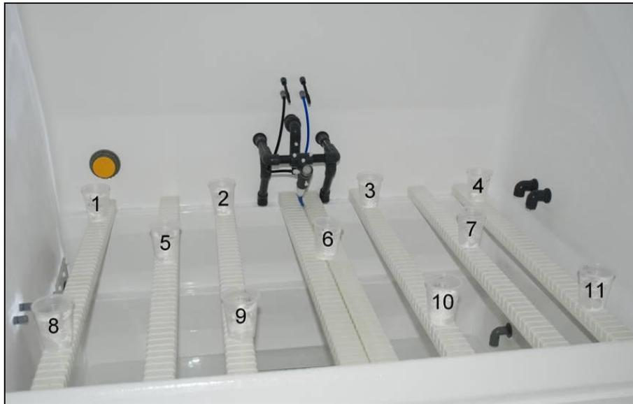
Figure V-4 : Contrôle de l'homogénéité de la pulvérisation.
