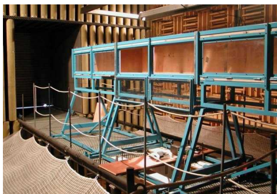
FIG. 4.1 – Soufflerie anéchoïque du Centre Acoustique de l'ECL
