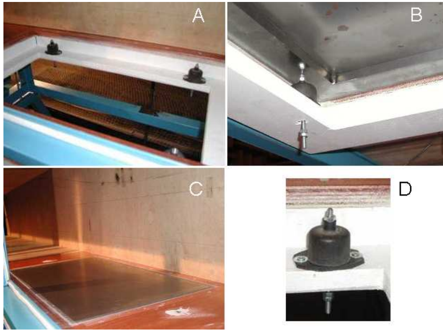
FIG. 4.3 – Photographies du montage pour le découplage entre la plaque et la veine d’essai. A : cadre en bois fixé sur la veine d’essai et plots amortissants, vu de dessus B : montage de découplage vu de dessous ; C : affleurement entre la plaque et la veine D : détail du système de réglage de l’affleurement
