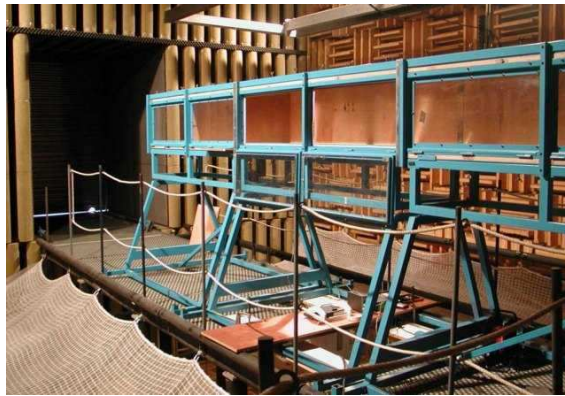
FIG. 4.1 – Soufflerie anéchoïque du Centre Acoustique de l'ECL
