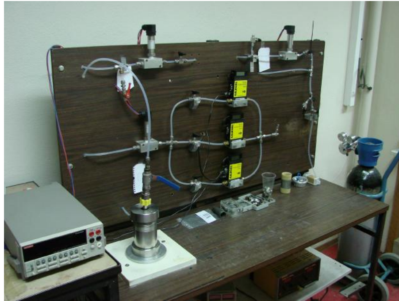
Figure 9 : Photo du dispositif d'acquisition des perméabilités au laboratoire
