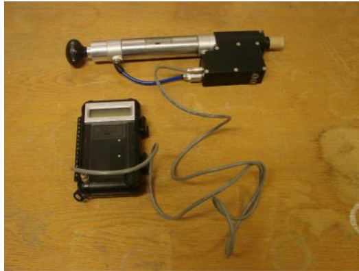
Figure 10 : Photo du perméamètre de terrain. En haut, le perméamètre, en bas l'unité de contrôle
