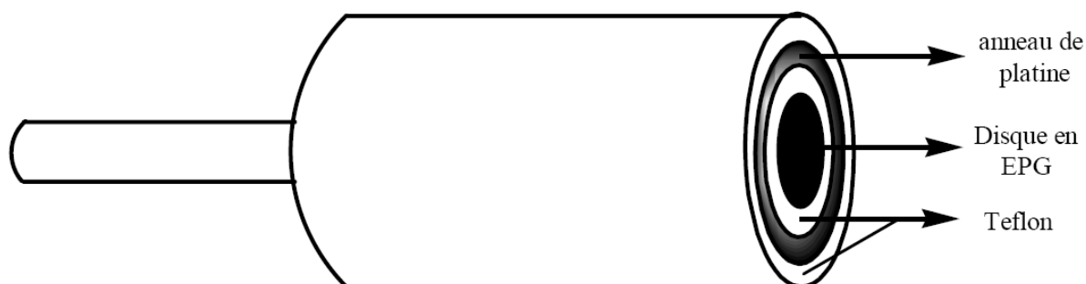
Figure 12 : Schéma d'une électrode rotative «disque-anneau» (RDE). 104
