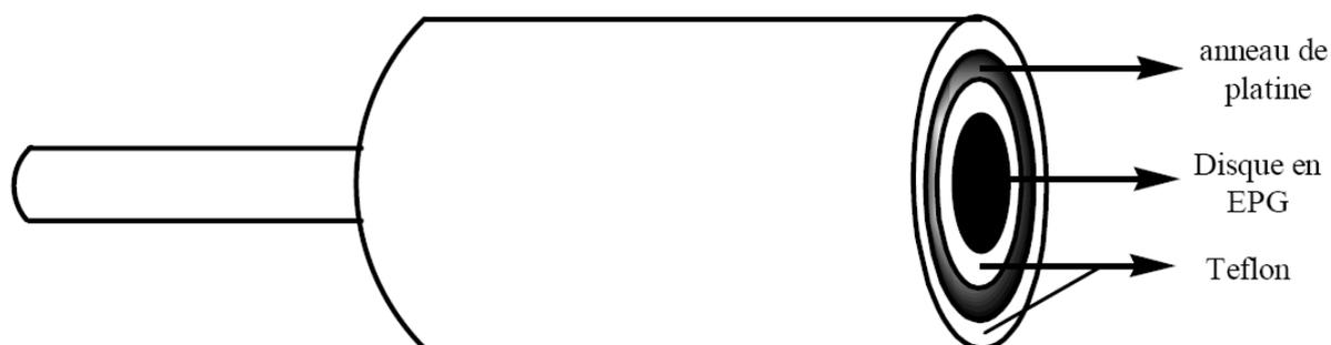
**Figure 12 :** Schéma d'une électrode rotative «disque-anneau» (RDE).<sup>104</sup>
