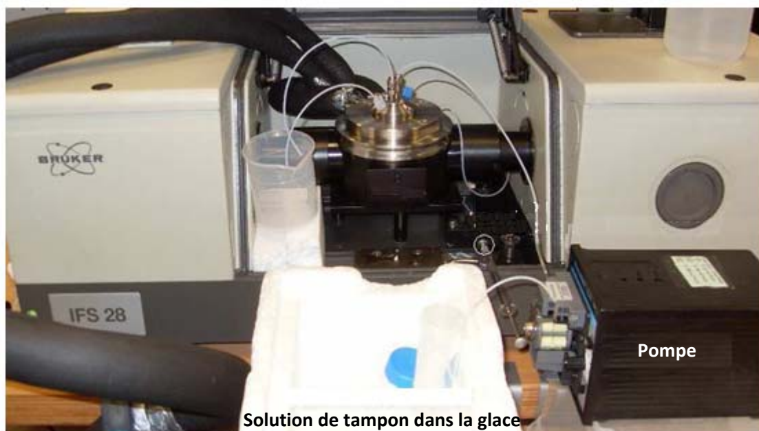
Figure 39 : une photo du montage expérimental utilisé lors des expériences de formation et suivi des intermédiaires de la CcO. Le circuit fermé se compose (de gauche à droite) : d'un flacon contenant la solution du tampon, d'une pompe assurant un débit constant égal à 0.2 ml/min et de la cellule à circulation disposée à l'intérieur du spectromètre Bruker. Les différents éléments sont reliés par des tuyaux en silicone.
