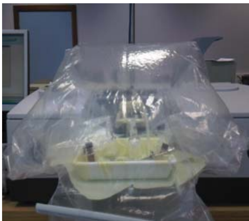
Figure 40 : une photo du montage expérimental utilisé lors des mesures des spectres de complexes Fe(II), Fe II -Cu I , Fe II -O 2 et Fe II -CO.
