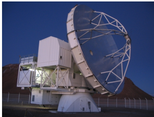
FIGURE 3.3 – L'antenne APEX de 12m de diamètre, prototype des antennes du projet ALMA.
