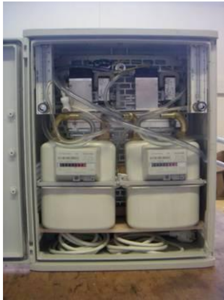
Figure 13: Echantillonneur d'aérosol utilisé lors de la campagne 2008
