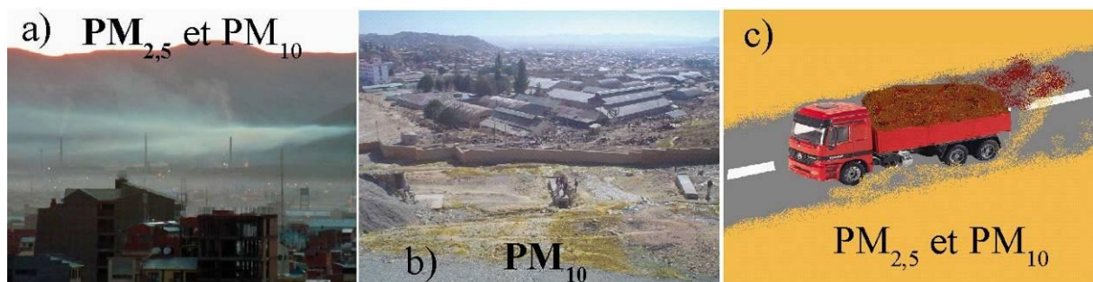
Figure 41: Principales sources de contamination atmosphériques mises en avant par l'étude des aérosols: a) émissions des fonderies, b) remise en suspension des terrils miniers, c) remise en suspension des minerais lors du transport de la mine vers la fonderie
