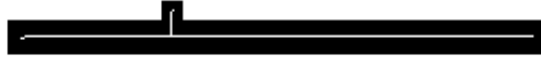
FIGURE 2.3 – Exemple de forme (noir) présentant une irrégularité sur le bord, son squelette (blanc) présente alors une barbule.
