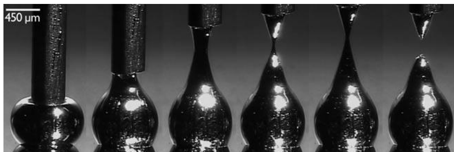
Figure 18 : Photographie successive de la formation d'une goutte de EGaIn en sortie d'une seringue. [33]
