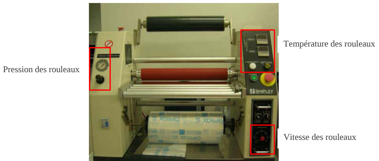
Figure 13 : Le laminoir Shipley et ses paramètres
