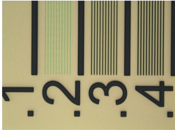
Figure 5: Image microscope optique d'une lithographie par faite par Stepper pour des lignes de 100, 200, 300 et 400 nm. La résolution obtenue est ici de 200 nm
