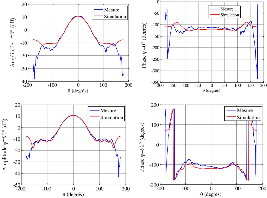
Figure 5.19. Directivité dans les plans  $\varphi=0^\circ$  et  $90^\circ$
