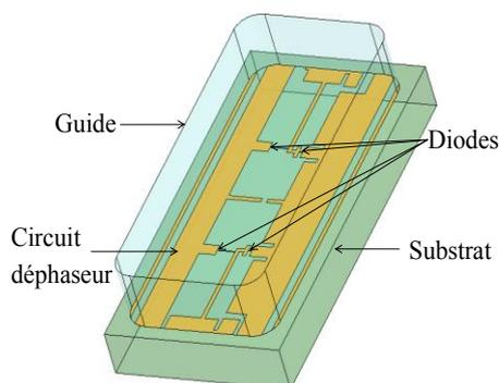
Figure 5.8. Modélisation de la cellule TMI avec HFSS™
