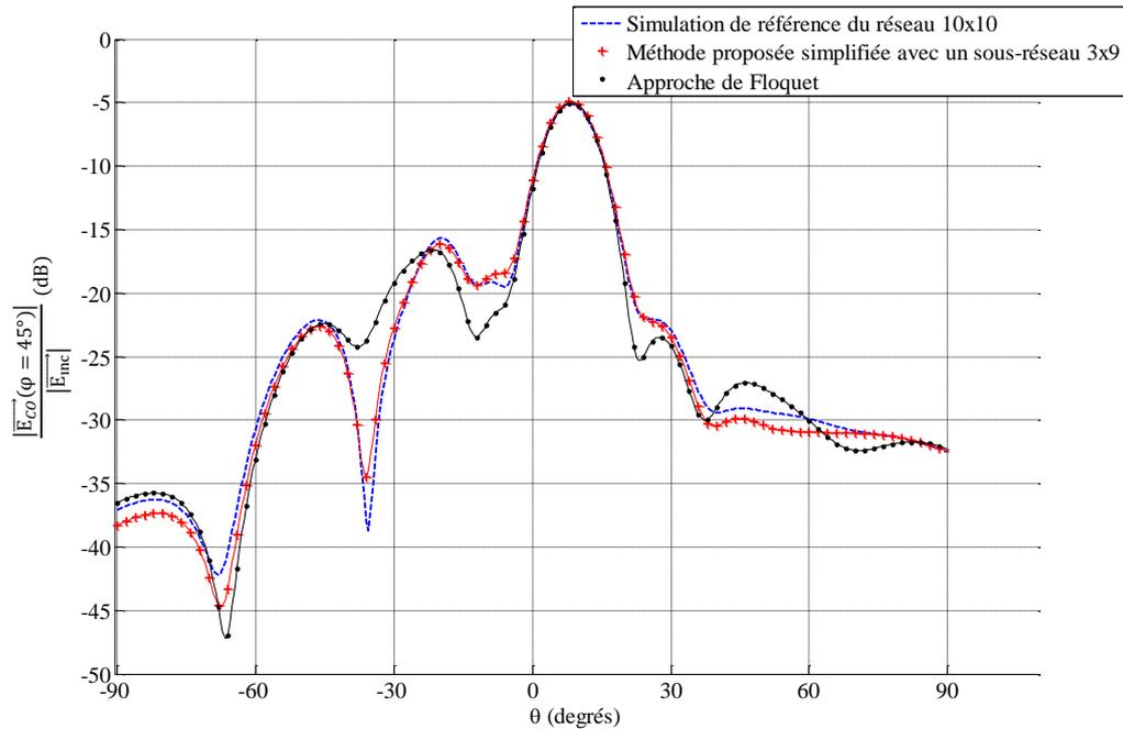
Figure 3.21. Réseau 10x10 ( $\theta_{\max}=10^\circ$ ,  $\varphi_{\max}=45^\circ$ ) : méthode proposée simplifiée
