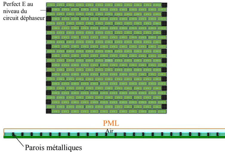
Figure 5.14. Simulation globale du réseau de 288 cellules
