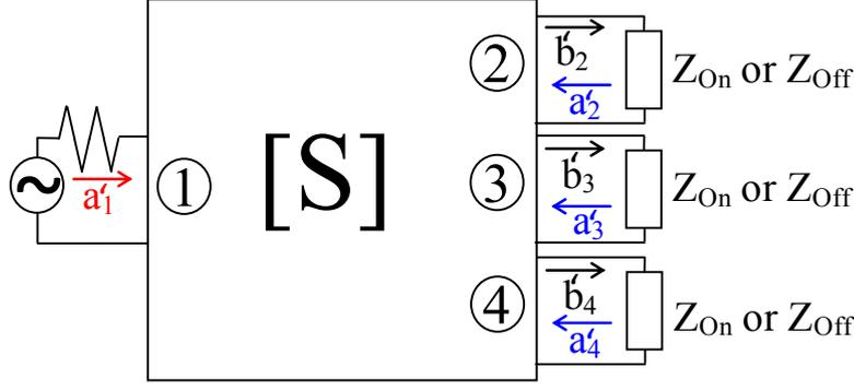
Figure 2.6. Principe détaillé : simulation circuit du sous-réseau chargé
