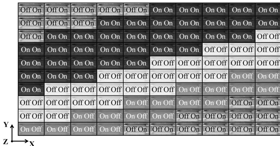
Figure 3.19. Réseau 10x10 ( $\theta_{max}=10^\circ, \varphi_{max}=45^\circ$ ) : configuration des diodes
