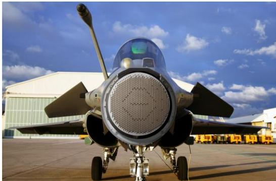
Figure 1.1. Radar RBE2-AA intégré au Rafale de Dassault Aviation
