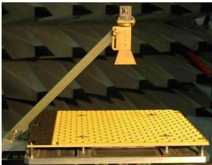
Figure 5.1. Etude d'un reflectarray à balayage électronique
