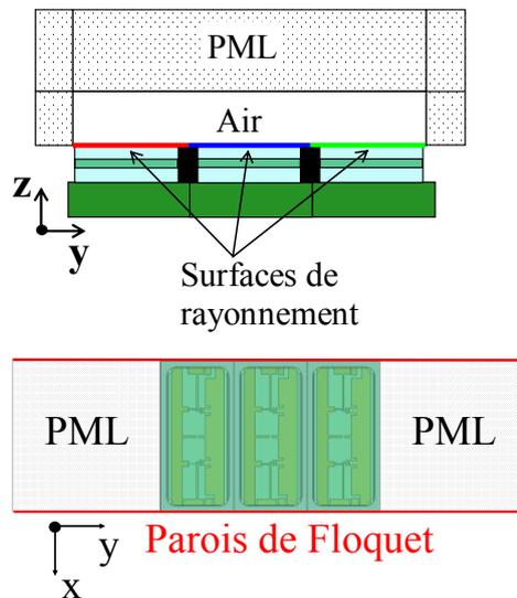
Figure 3.2. Sous-réseau de 3 cellules dans le plan E
