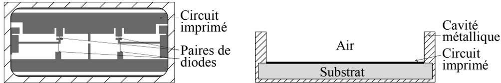
Figure 1.29. Modèle de simulation de la cellule TMI
