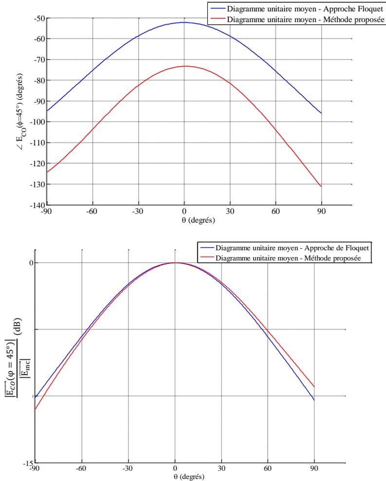
Figure 4.6. Diagramme de rayonnement moyen de la cellule dans le plan  $\varphi=45^\circ$
