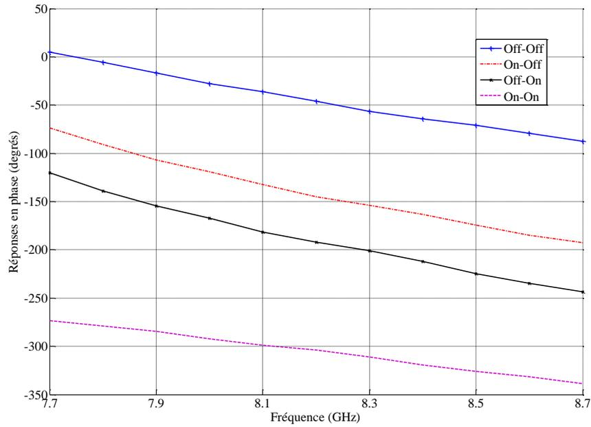
Figure 1.27. Réponses en phase mesurées de la cellule TMI
