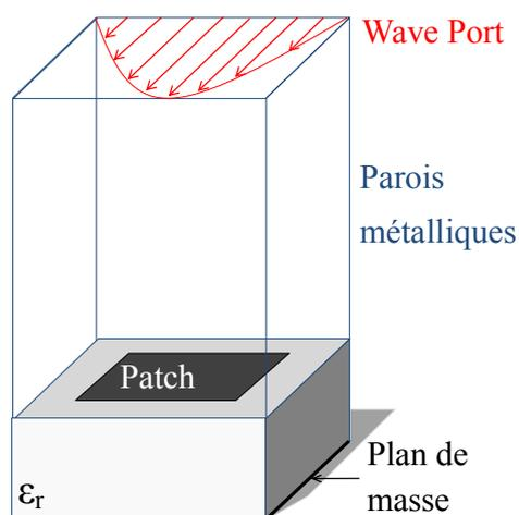
Figure 1.14. Simulation d'une cellule en guide d'onde
