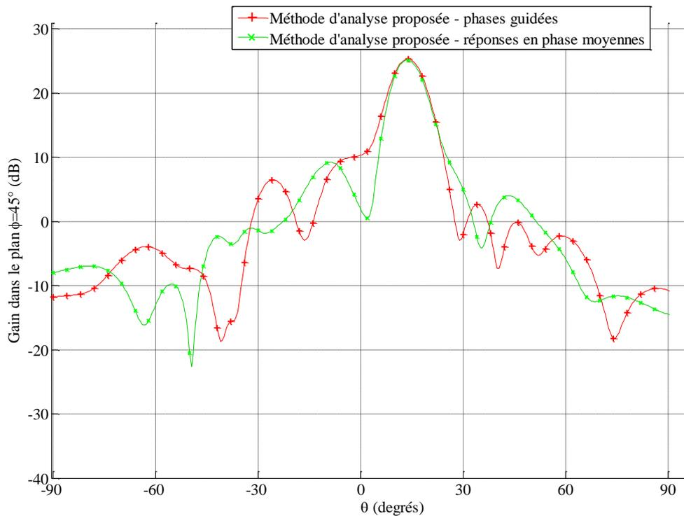
Figure 5.31. Diagramme de rayonnement pour ( $\theta_{\max}=13,5^\circ$  ;  $\varphi_{\max}=45^\circ$ )
