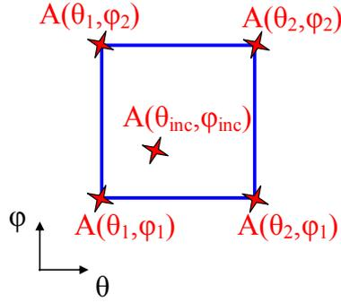
Figure 2.13. Schéma de principe de l'interpolation 2D
