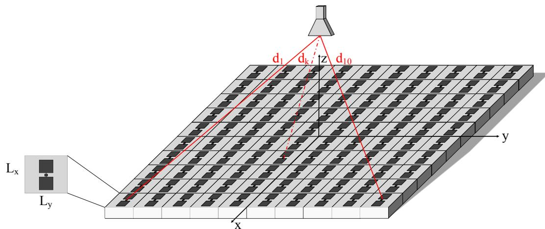
Figure 4.1. Synthèse d'un réseau 10x10 de cellules canoniques
