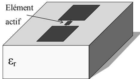
Figure 1.19. Cellule canonique reconfigurable à 2 états de phases
