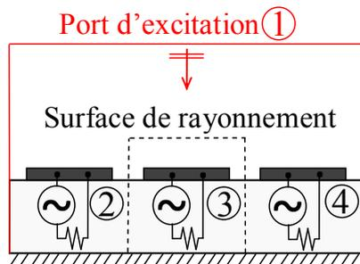
Figure 2.18. Méthode simplifiée : simulation électromagnétique du sous-réseau
