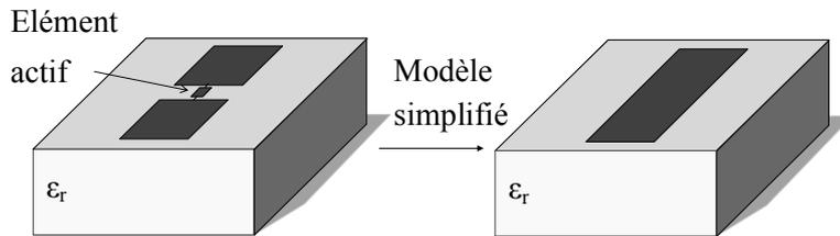
Figure 2.19. Modèle simplifié de la cellule canonique reconfigurable
