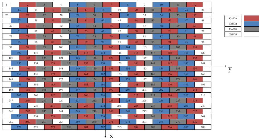
Figure 5.15. Réseau de 288 cellules - dépointage dans la direction ( $\theta_{\max}=60^\circ$ ,  $\varphi_{\max}=90^\circ$ )
