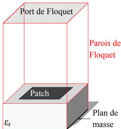
Figure 1.12. Simulation d'une cellule avec l'approche Floquet
