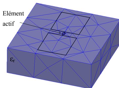
Figure 1.24. Maillage de la cellule canonique reconfigurable
