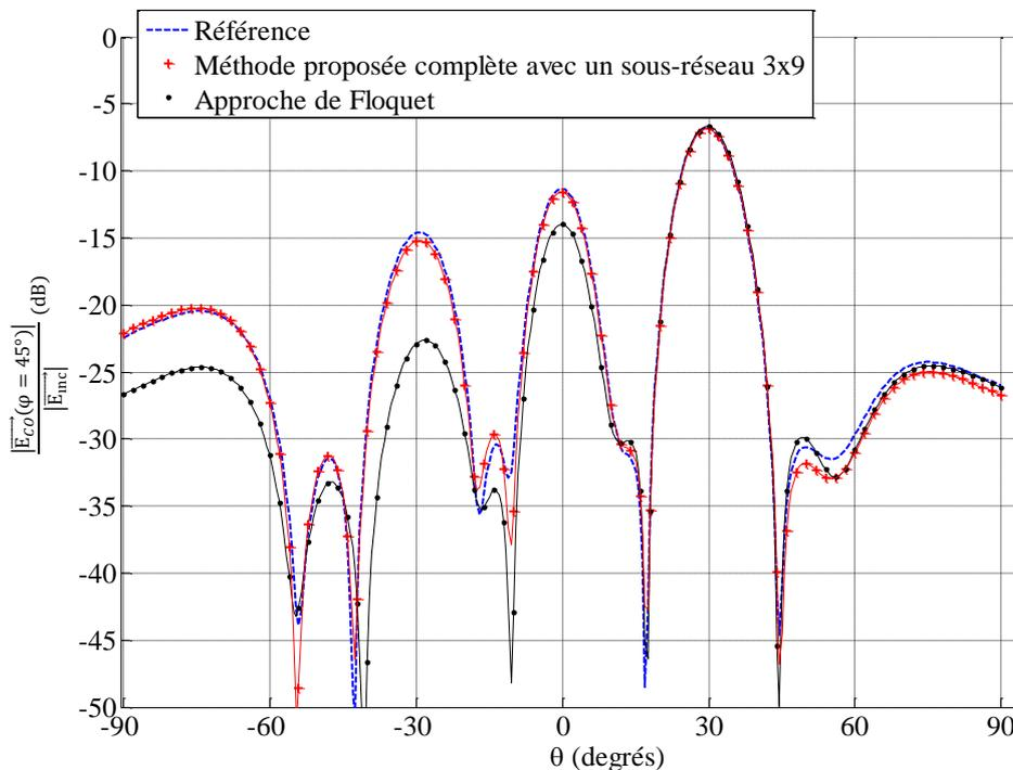
Figure 3.23. Réseau 10x10 ( $\theta_{\max}=30^\circ$ ,  $\varphi_{\max}=45^\circ$ ) : méthode proposée complète
