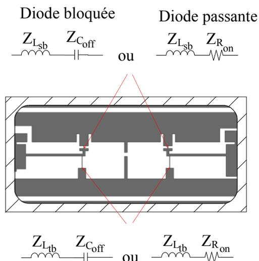
$Z_{Lsb}$  : effet selfique sur la charge au niveau du petit bonding (sb pour small bonding)
