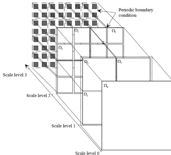
Figure 1.11. « Scale Changing Technique » appliquée à un reflectarray
