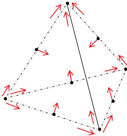
Figure 1.23. Tétraèdre issu du maillage à éléments finis
