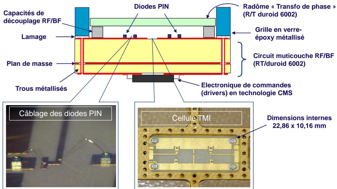
Figure 1.26. Schéma explicatif de la cellule reconfigurable TMI
