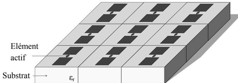
Figure 2.9. Sous-réseau 3x3 pour l'analyse du reflectarray 10x10
