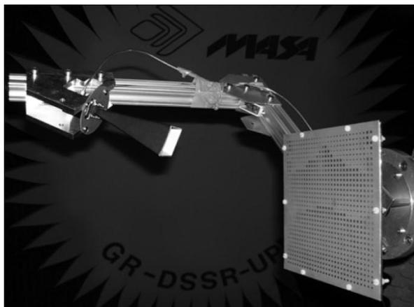
Figure 1.13. Reflectarray passif à double polarisation linéaire
