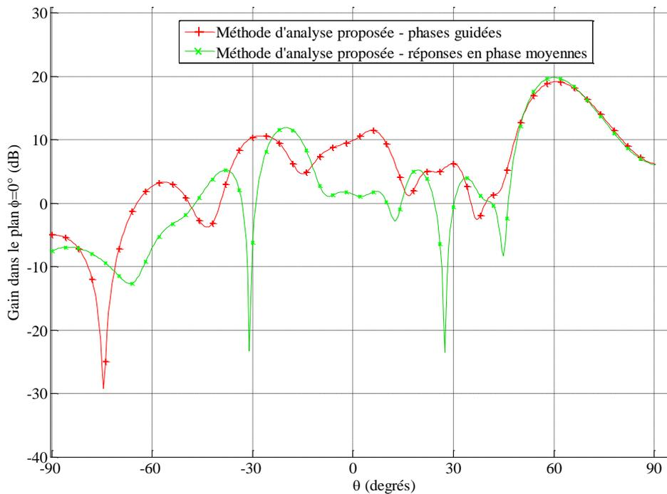
Figure 5.30. Diagramme de rayonnement pour ( $\theta_{\max}=62^\circ ; \varphi_{\max}=0^\circ$ )
