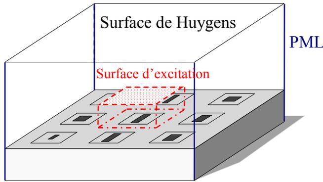
Figure 1.17. Analyse d'une cellule avec l'approche de la cellule environnée
