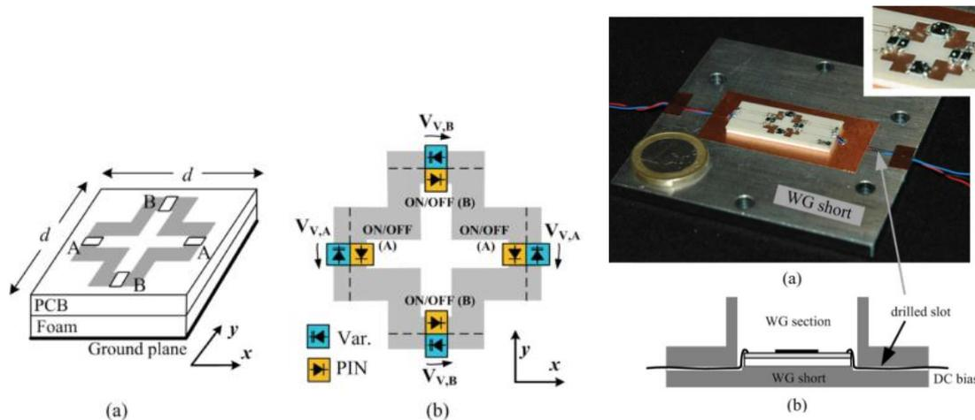
Figure 1.6. Principe de la cellule reconfigurable à base de diodes PIN et varactors
