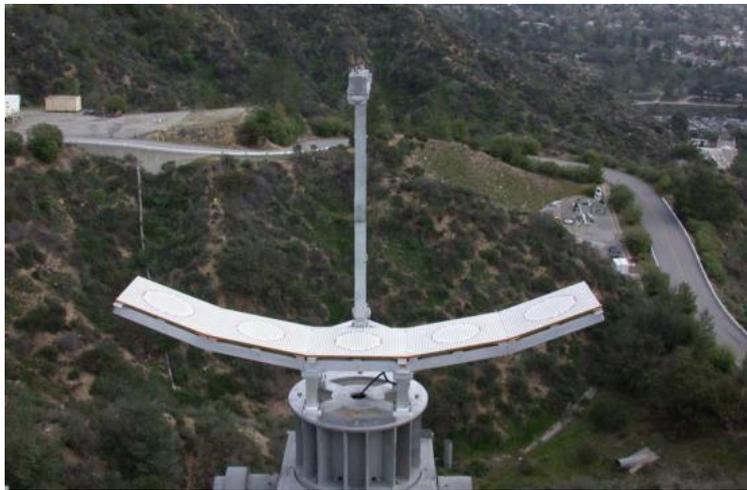
Figure 1.5. Reflectarray déployable pour radar altimètre
