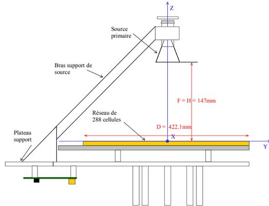
Figure 5.2. Configuration de l'antenne
