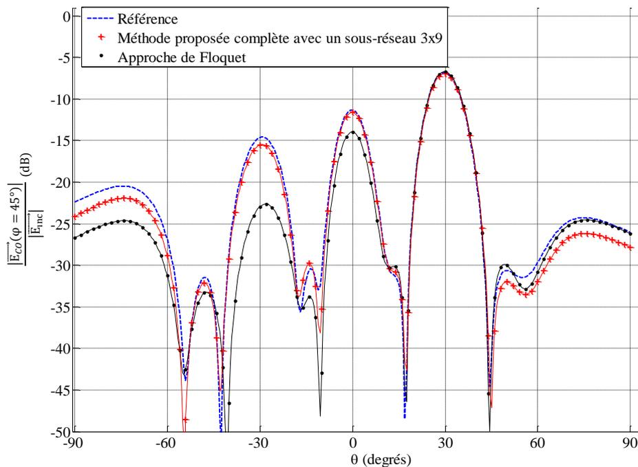
Figure 3.24. Réseau 10x10 ( $\theta_{\max}=30^\circ, \varphi_{\max}=45^\circ$ ) : méthode proposée simplifiée
