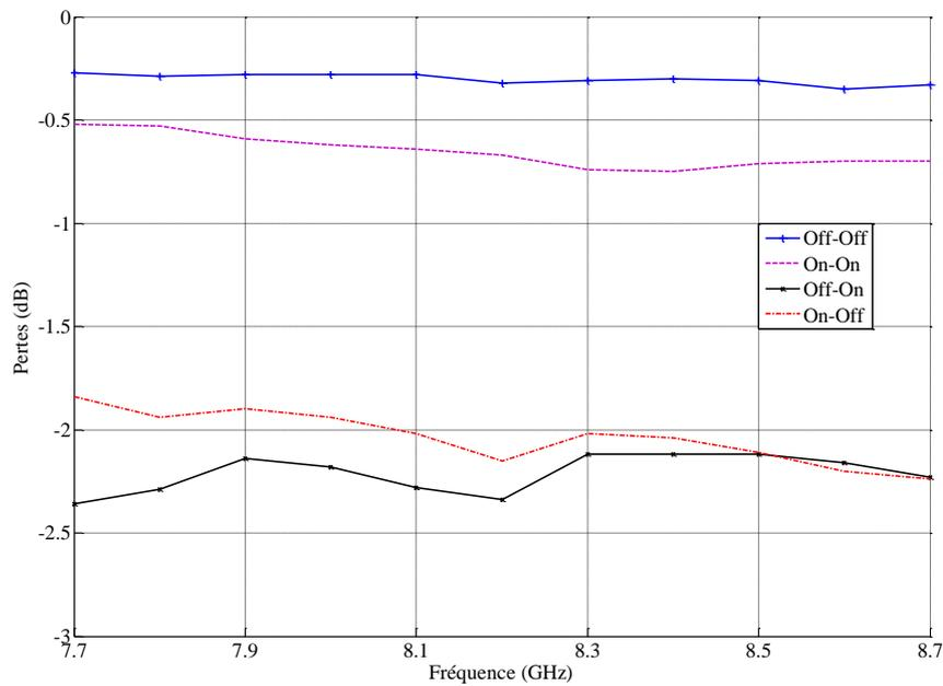
Figure 1.28. Pertes mesurées de la cellule TMI
