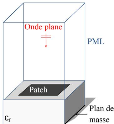
Figure 1.16. Simulation d'une cellule avec l'approche isolée
