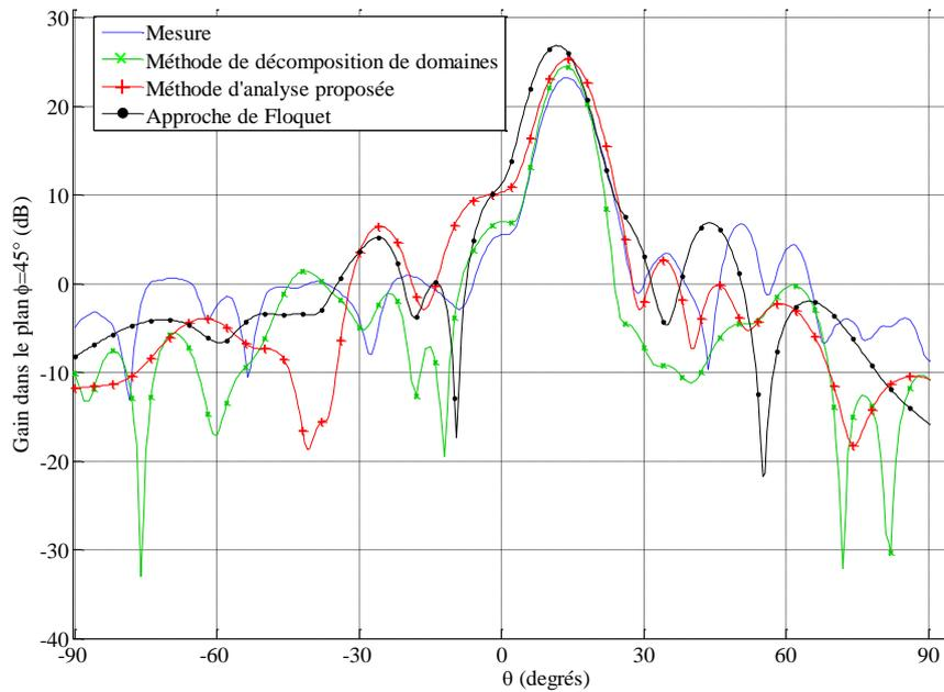
Figure 5.26. Diagramme de rayonnement pour ( $\theta_{\max}=13,5^\circ$  ;  $\varphi_{\max}=45^\circ$ )
