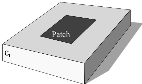
Figure 1.8. Cellule canonique passive composée d'un patch au-dessus d'un substrat
