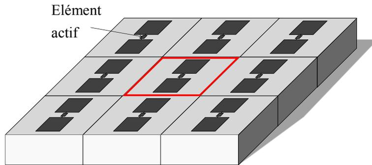
Figure 4.2. Sous-réseau 3x3 de cellules canoniques reconfigurables
