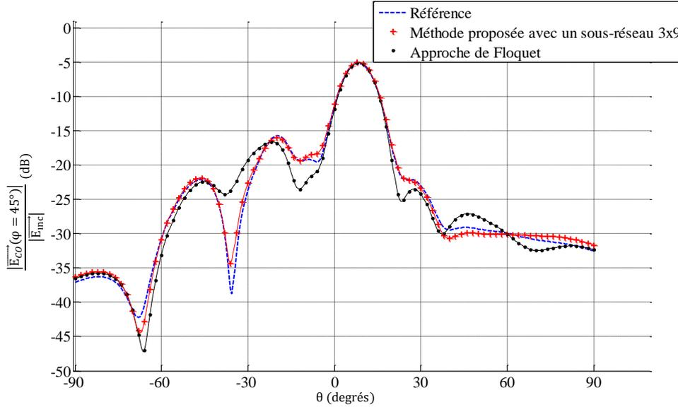
Figure 3.20. Réseau 10x10 ( $\theta_{\text{max}}=10^\circ$ ,  $\varphi_{\text{max}}=45^\circ$ ) : méthode proposée complète
