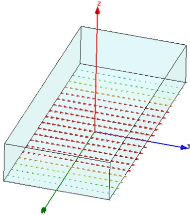
Figure 3.13. Propagation du mode TE10 dans le guide
