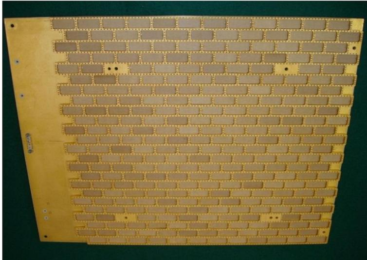
Figure 5.6. MCMF face RF : Réseau de 288 cellules
