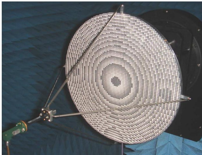
Figure 1.4. Reflectarray passif à réseau métallique circulaire fonctionnant à 75GHz
