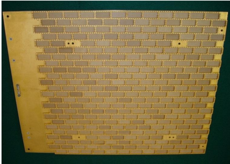
Figure 5.6. MCMF face RF : Réseau de 288 cellules
