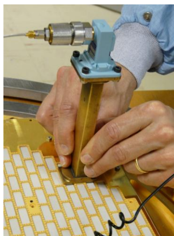
Figure 1.15. Mesure d'une cellule de reflectarray en guide d'onde
