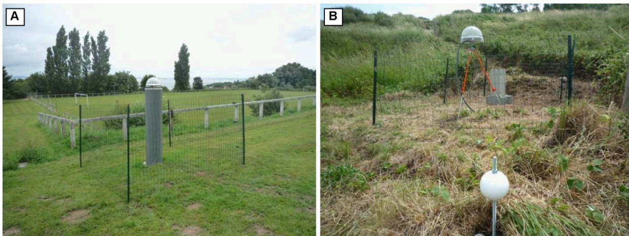
(A) Antenne fixe implantée en zone stable, (B) Station VLRB avec antenne et boîtier dans lequel se trouve le data logger
