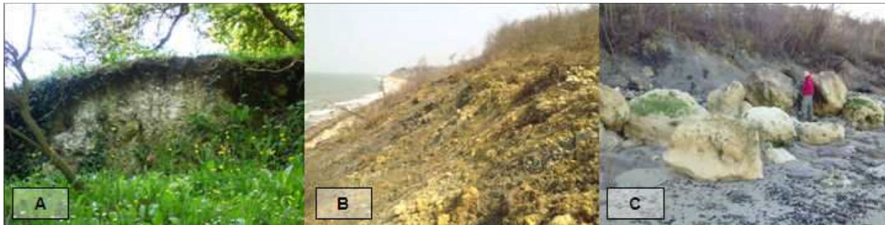
(A) Affleurement crayeux dans le Parc des Graves , (B) Partie médiane du glissement où la craie se présente sous forme de blocs de tailles modestes (< 1 m) très altérés et transportés par des glissements superficiels, (C) Blocs de craies déposés sur l'estran.
