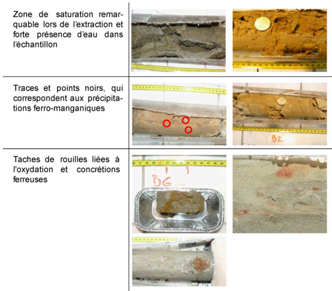
Figure 4-4. Identification des zones saturées dans les carottages.
