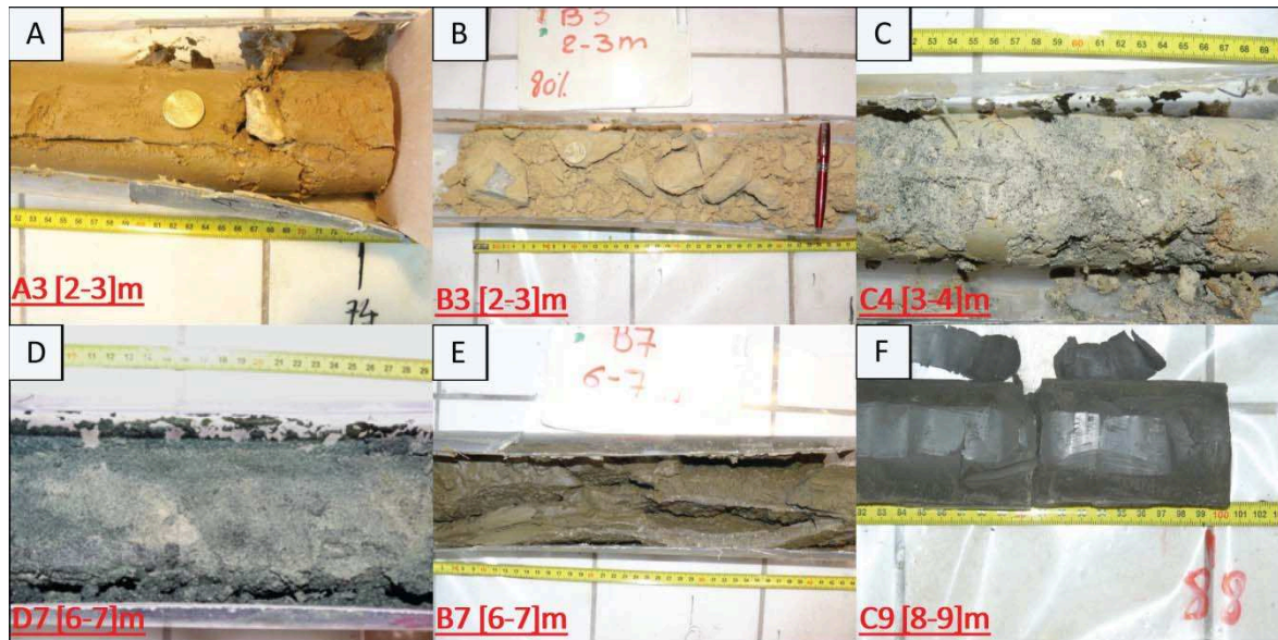
(A) Formation superficielle limoneuse à débris de craie, (B) Sable et débris de craie et silex, (C) Couche argilo-limoneuse intermédiaire entre craie et sables glauconieux, (D) Sable glauconieux vert-noir, (E) Sable albien vert-kaki, (F) Marne bleue-grise.
