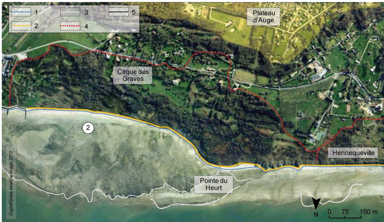
(1) Niveau des hautes eaux, (2) Haute plage, (3), Limite du platier rocheux, (4) Zone instable, (5) Aménagement côtier.
