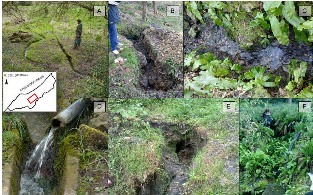
(A) Eaux de sources drainées par rigoles entretenues par les propriétaires en mars 2008, (B) Mise à jour d'une source en janvier 2010, (C) Mesure de débit de source en janvier 2010, (D) Source captée et évacuée jusqu'au pied du versant par drain ouvert en béton en juin 2010, (E) Creusement des formations superficielles liée à une source permanente en juin 2010, (F) Érosion importante laissant apparaître plusieurs sources en juin 2010.
