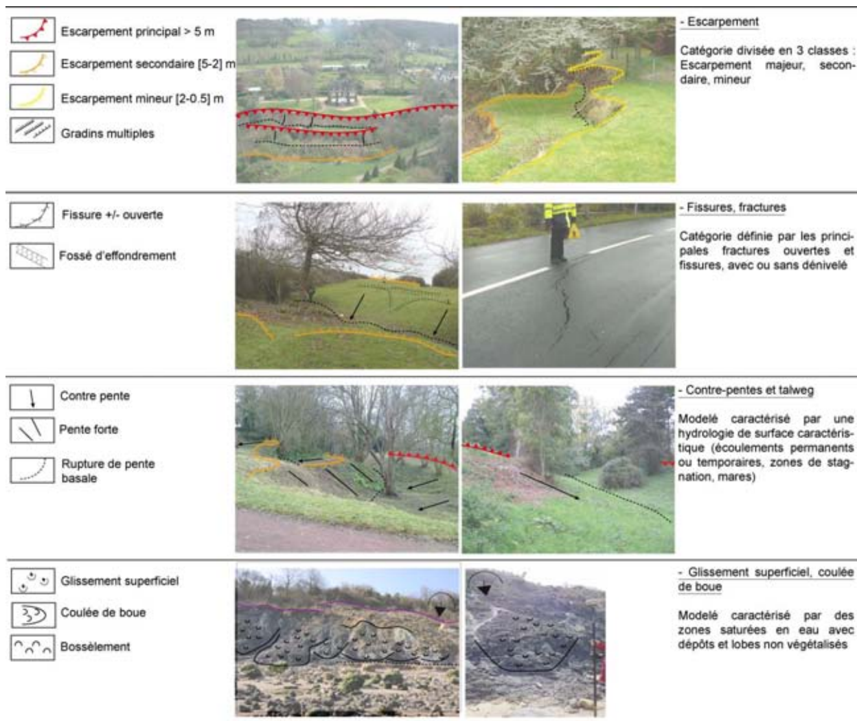
Figure 3-3. Interprétation des formes principales et des modelés relevés sur le terrain.
