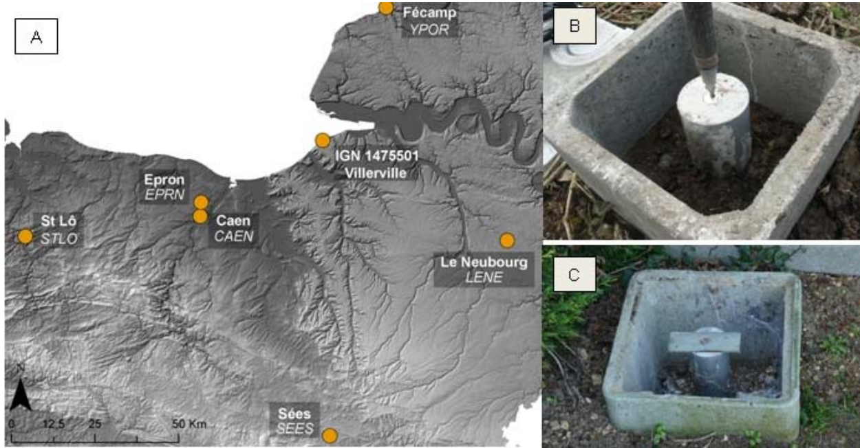
(A) Localisation des stations GPS de référence RGP et IGN utilisées pour les traitements de données dGPS, (B) Vue d'une borne munie d'un repère de centrage, (C) Vue d'une borne avec embase de nivellement à vis micrométrique.
