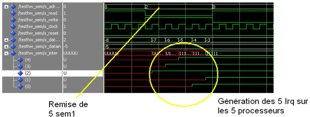
FIGURE A.9: Post de sémaphore et génération d'irq
