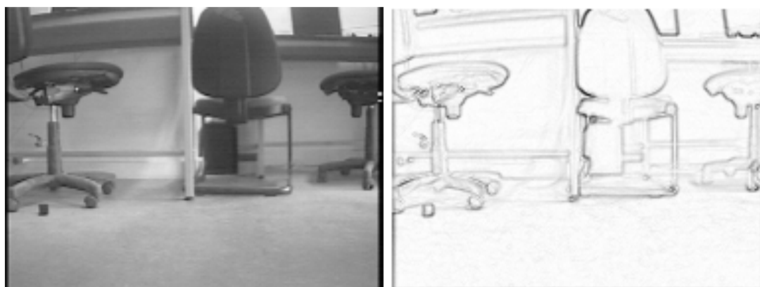
FIGURE 1.3 – Gradient - Image provenant de la caméra à gauche, à droite son gradient. Pour une meilleure lisibilité du gradient dans le reste du document, les couleurs sont inversées pour toutes les images, sauf celles de la caméra. Point clair : valeur faible, point sombre : valeur élevée
