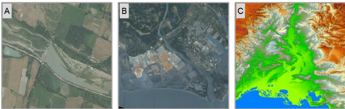
Figure 1.8. Illustrations de différents types de raster : une orthophotographie de la BD Ortho® (A), une image Spot 5 (B) et un modèle numérique de terrain (C) (Sources : Géoportail : http://www.geoportail.gouv.fr/accueil ).
