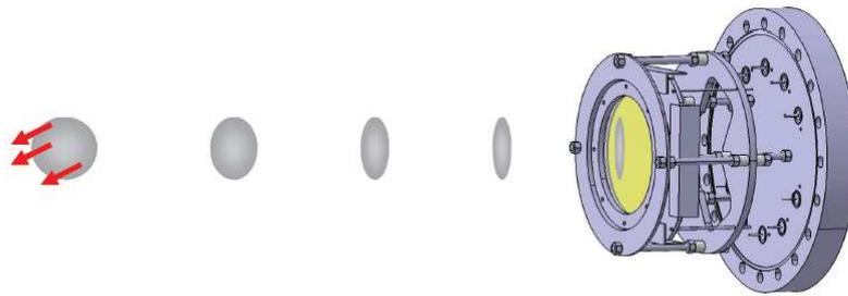
**FIGURE 2.22:** Représentation schématique de la focalisation temporelle des ions de recul ayant une même impulsion initiale sur le détecteur associé.
