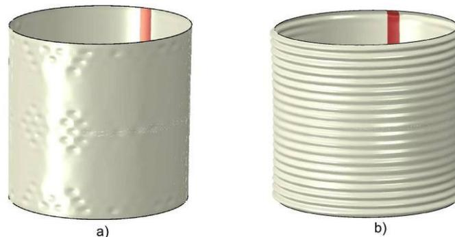
**Figure 6.30** Modes critiques PN observés numériquement,  $R/t = 1350$ , acier, a) : pointes de diamant, b) : axisymétrique généralisé
