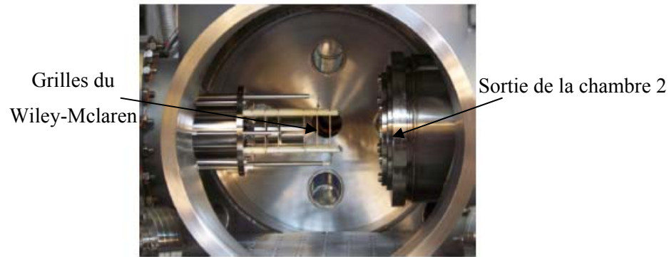
Figure III.9 Photographie de la chambre d'ionisation montrant l'assemblage de la chambre de combustion avec le TOF-MS
