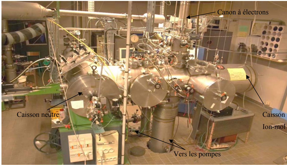
Figure II.2.6 Photographie du dispositif CRESU Ion-Molécules utilisé à Rennes
