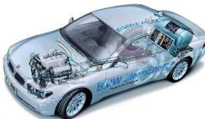
(b) Implantation d'un stockage cryogénique couplé à un moteur à combustion interne [7]
