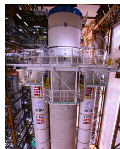
Fig. 1.8: Ariane 5, étage cryogénique [14]
