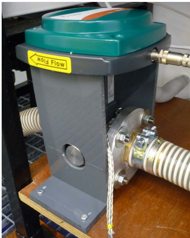
Photo II-9 : Sonde Kajaani TS installée sur le banc expérimental (M. Lepot)
