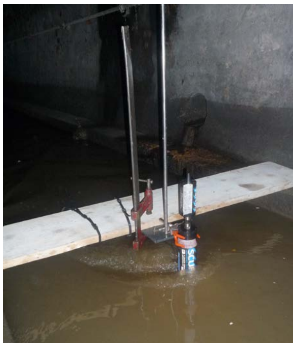
Photo III-1 : Traçages quai Arloing - Dispositif d'installation du SCUFA (à gauche, M. Lepot), injection de 4.7 mL de Rhodamine WT (à droite, service de métrologie du Grand Lyon)
