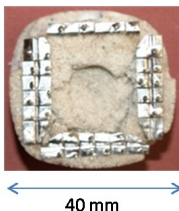
Figure 118. Vue en coupe du sable contenu dans un fusible MERSEN. Le fusible céramique est parallélépipédique de base carrée de côté 60 mm. Les lames d'argent ont été rabattues à plat sur le sable afin de faciliter leur visualisation
