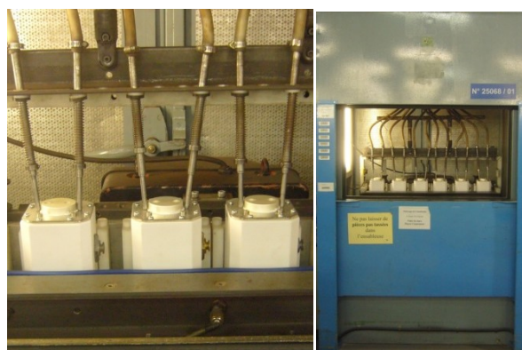
Figure 2. Ensableuses industrielles. Des chocs sont imposés à une fréquence de 50 Hz pendant que le sable est introduit par le dessus de la boîte fusible
