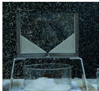
Figure 64. Mesure des angles de talus. Angle de talus \theta_t = 37,5^\circ
